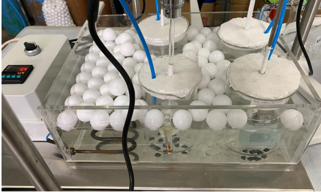
Şekil 3.7 Yapay vücut sıvısı ile biyoaktivite testi deney düzeneği.
