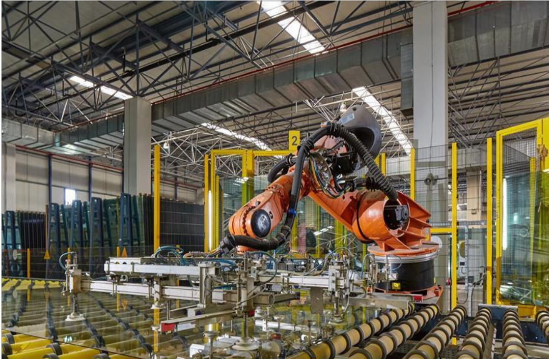
Şekil 3.8 : Montaj hattından örnek bir otomatik cam alma kolu (Url-1).
