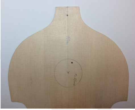
Şekil 88. Üst Ses Tablosu Kafes Yeri Çizimi
