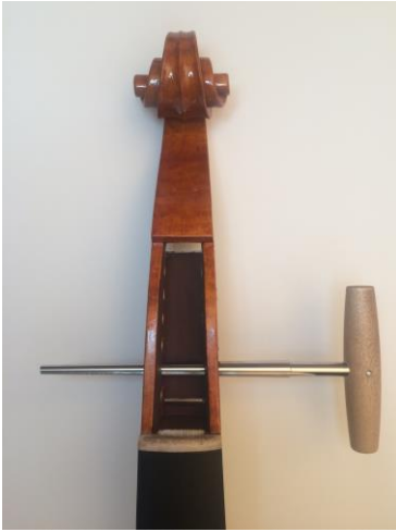
Şekil 179. Burgu Deliklerinin Rayba ile Açılması
