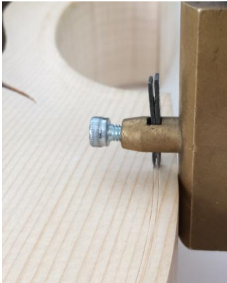
Şekil 101. Fileto Bıçağıyla Çizim
