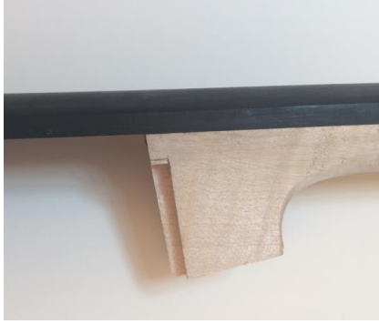
Şekil 149. Sap Arkasındaki Eğim
