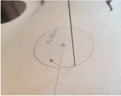
Şekil 89. Üst Ses Tablosu Kafes Yeri Kesimi
