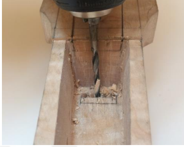
Őekil 129. Ahenk Telleri Geiř Yerinin Matkap ile Delinmesi
