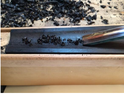
Şekil 142. Tuşe İç Derinliğinin Yapılması
