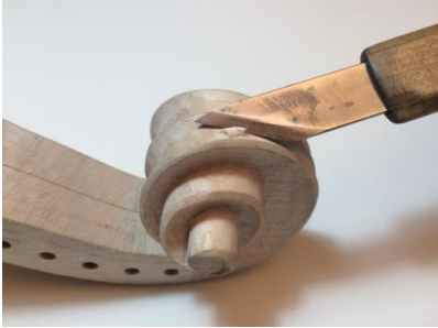
Őekil 124. Salyangozun DıŐ Tarafına Derinlik Yapılması
