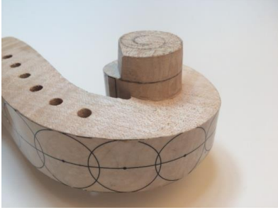
Şekil 122. Salyangoz Kalınlık Çizimi
