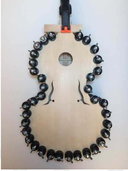
Şekil 100. Üst Ses Tablosu Yapıştırma
