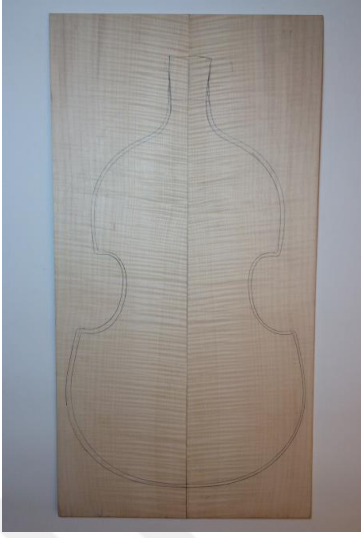
Şekil 46. Alt Ses Tablosu Çizimi
