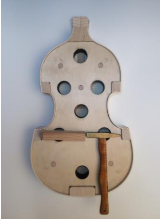
Şekil 63. Takozlara Çekiçle Vurulması
