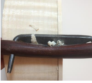
Şekil 62. Alt Ses Tablosunun Fazlalıklarının Alınması
