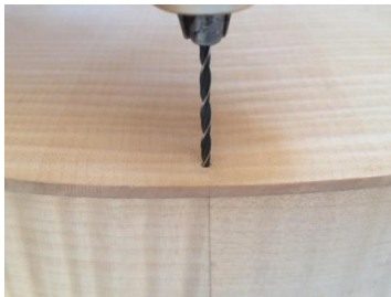
Őekil 59. Alt Ses Tablosunun Matkap ile Delinmesi
