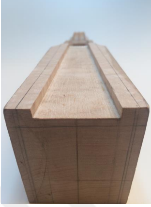
Őekil 133. Ahenk Telleri Kanal Derinliđi
