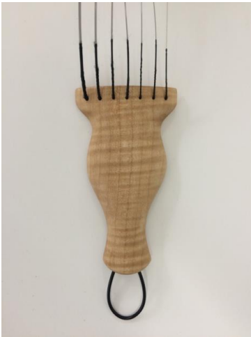
Şekil 188. Tellerin Kuyruğa Takılması
