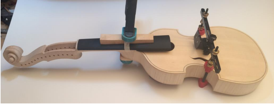
Őekil 152. Sapın IŐkence ile Sabitlenmesi
