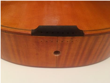
Şekil 177. Alt Eşik Yapıştırılması
