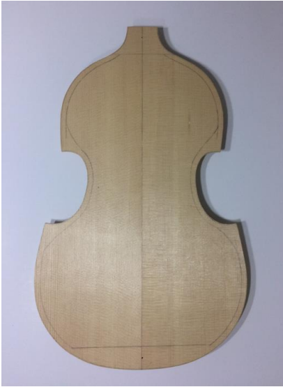
Őekil 80. st Ses Tablosu Kenar izimi
