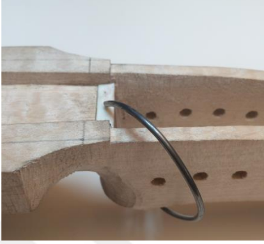
Şekil 135. Ahenk Telleri Eşiğinin Yapıştırılması
