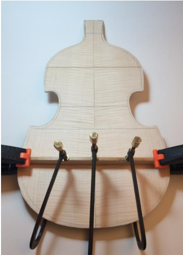
Şekil 49. Alt Balkon Yapıştırma
