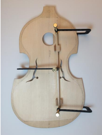
Şekil 95. Bas Balkon Yapıştırılması
