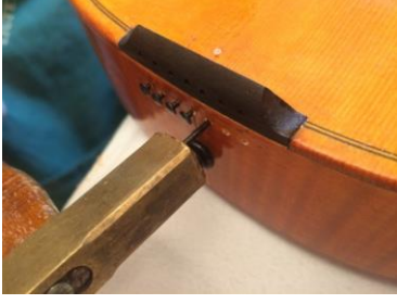
Şekil 186. Ahenk Telleri Çivilerinin Yapılması
