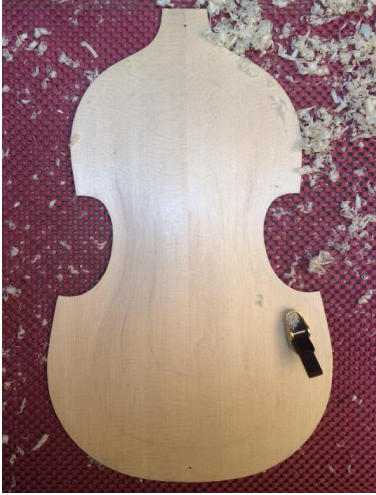
Şekil 78. Parmak Rende ile Yüzey Temizliği
