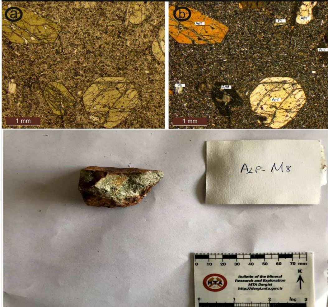
Şekil 26. Çaycuma formasyonuna ait silttaşlarında plajiyoklas (plj), amfibol (amf), serizit ve kuvarslar (a: //N, b: +N, c: el örneği)
