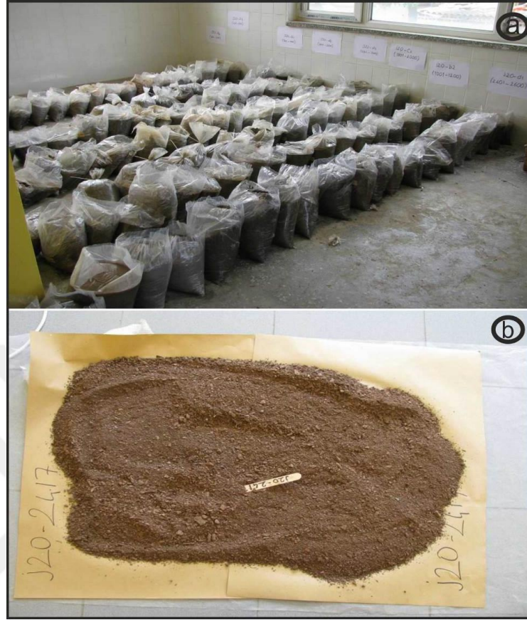
Şekil 8. Dere sedimanı ve toprak örneklerinin kurutulması; a) Sahadan alınan örneklerin numune toplama biriminde depolanması b) Örneklerin doğal şartlarda kurutulması için serilmesi
