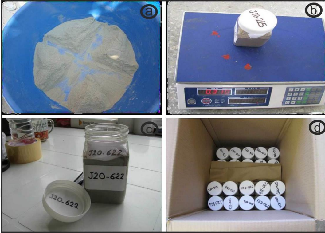
Şekil 9. Analiz için hazırlanan örnekler; a) Elenen ve çeyreklenen örnek görünümü, b) Örneklerin tartılması, c) Örneklerin numune kavanozlarına alınması, d) Kavanozların kutulara yerleştirilmesi.
