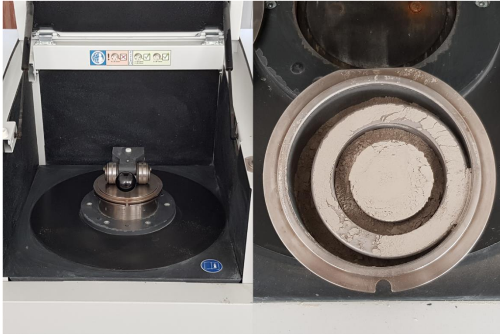
Şekil 5.8. Retsch RS200 model diskli öğütücü kullanılarak öğütülen örnek.
