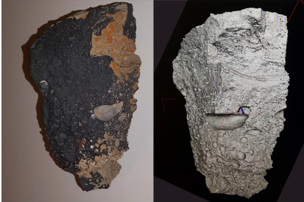
Şekil 4.5. Taraması yapılan makro örnek ve örneğin oluşturulan katı modeli (Voksel).
