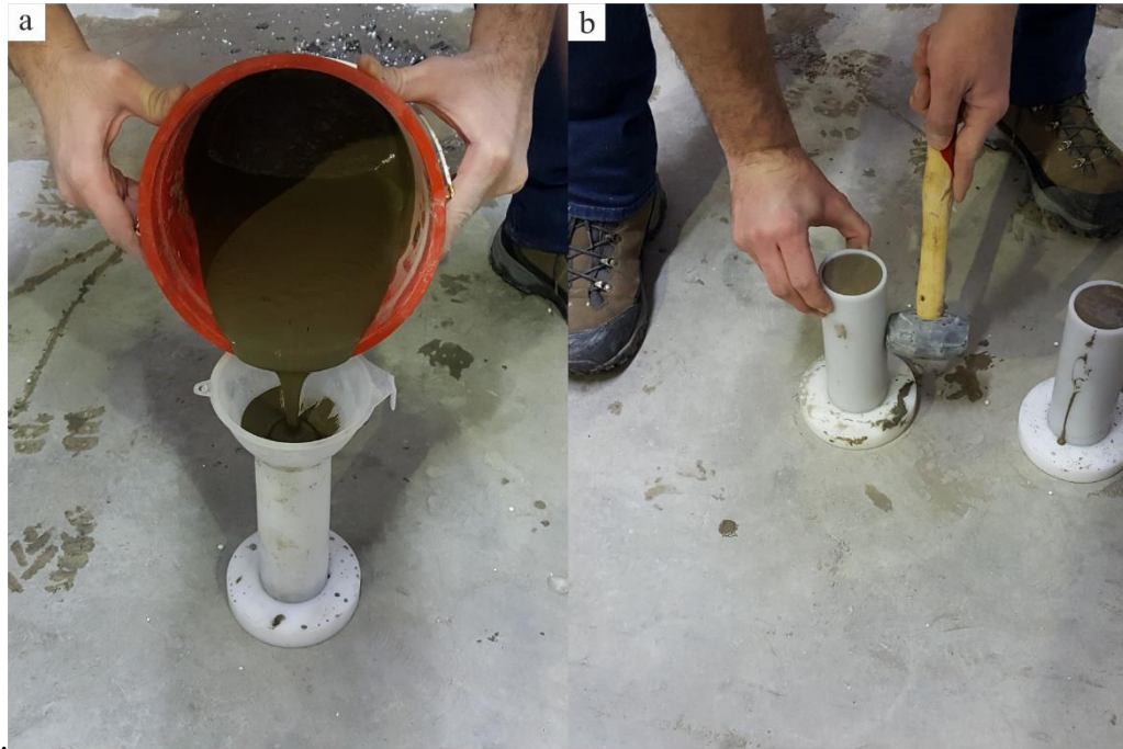
Şekil 5.33. (a) Hazırlanan karışımın örnek hücre sine aktarılması ve (b) Hapsolmuş baloncukların ortamdan uzaklaştırılması.
