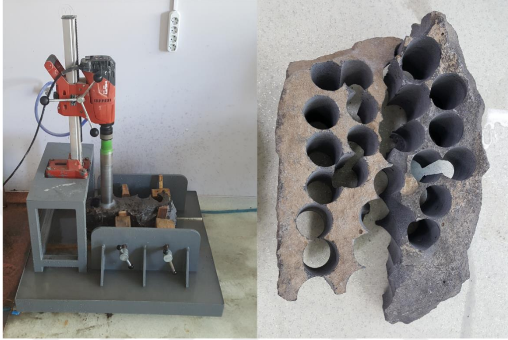
Şekil 5.2. Van Yüzüncü Yıl Üniversitesi Jeoloji Mühendisliği Bölümü Laboratuvarı'nda karot alma çalışmaları.
