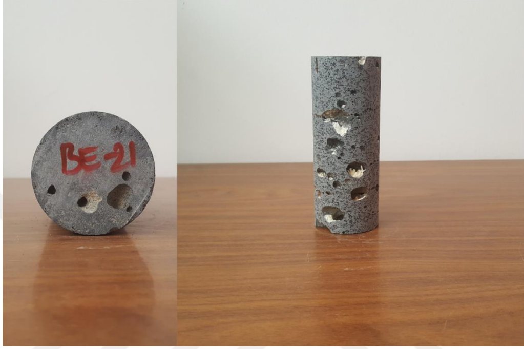
Şekil 4.7. Karot yüzeyi tarama yöntemi uygulanan BE-21 örneğinin görünümü.
