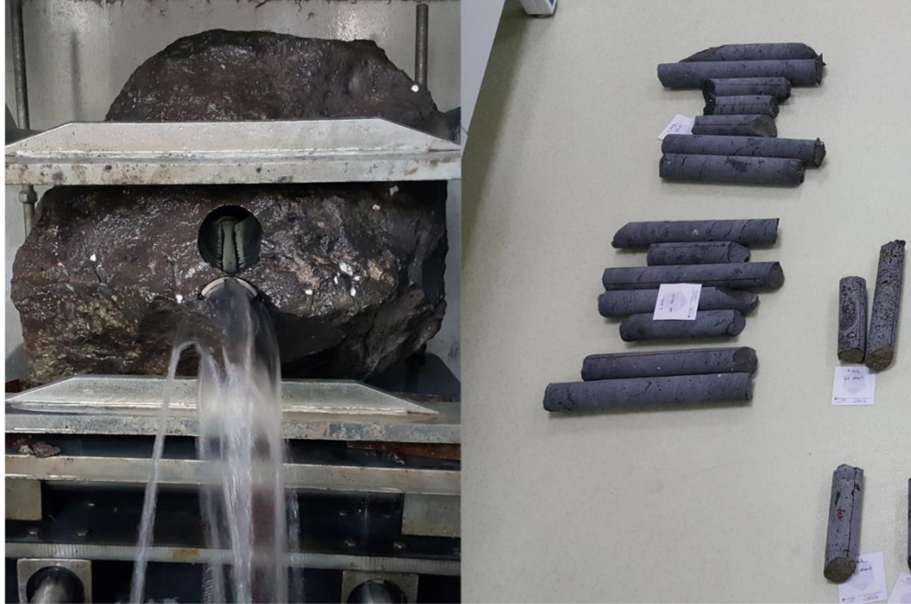
Şekil 5.1. Kütahya Dumlupınar Üniversitesi Jeoloji ve Maden Mühendisliği Bölümü Laboratuvarları'nda karot alma çalışmaları.
