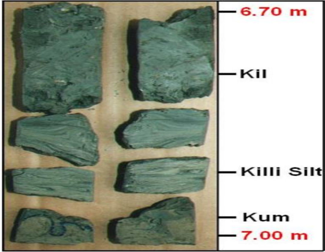
Şekil 2.1. Sondaj logundan alınan numune [74].
