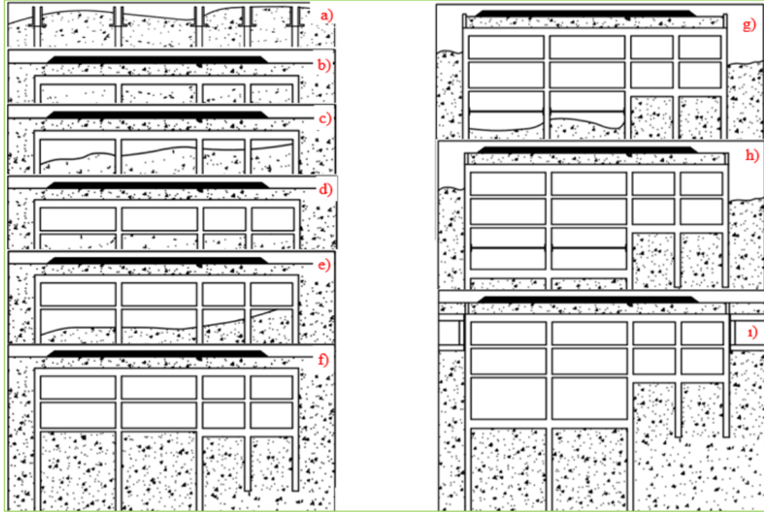
Şekil 3.5. Yukarıdan aşağıya (top-down) kazı yöntemi [16].
