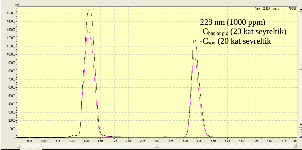
Şekil 4-20. 37 °C metanol içerisinde 1000 ppm SAM ve FLU ortamının kromatogramı (Alıkonma zamanları salmeterol ksinafoat için 1.354 dakika, flutikazon propiyonat 3.135 dakika)
