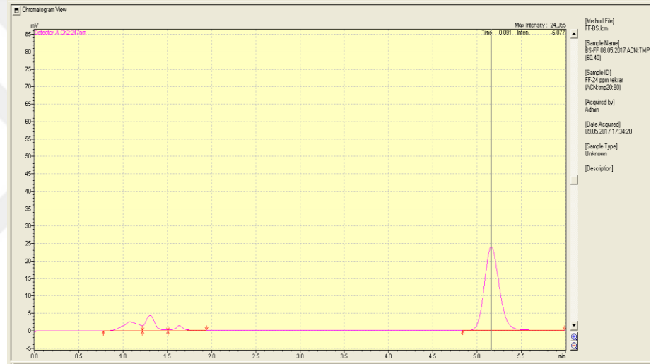
Şekil 4-35. 50 ppm budesonid standart çözeltisinin kromatogramı (Alıkonma zamanı: 2.954)
