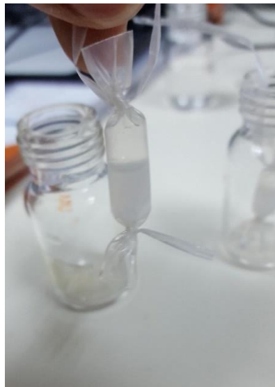
Şekil 3-4. Diyaliz membranları içerisinde salım denemesinin hazırlanması
