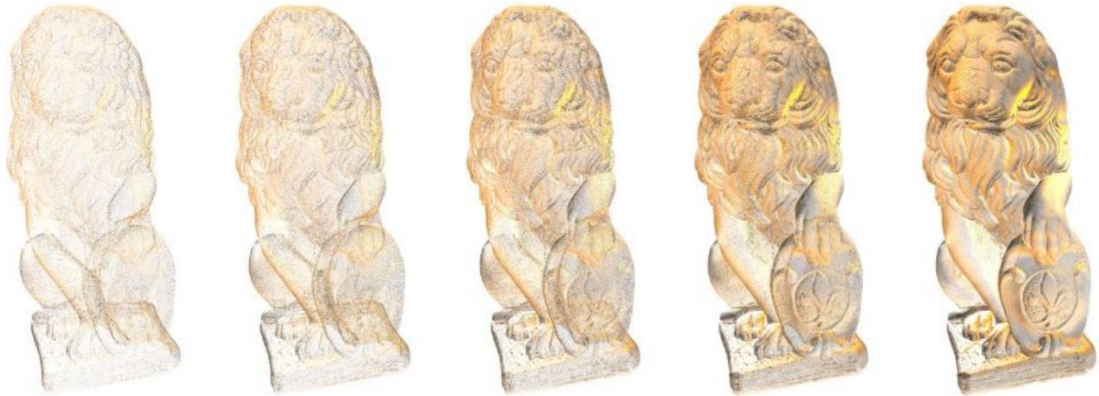
Şekil 2.3: Çeşitli ayrıntı seviyelerinde (LoD) nokta bulutları [28].
