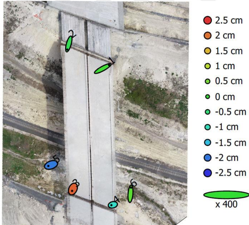
Şekil 3.27: Yer kontrol noktaları yeri ve hata değerleri.
