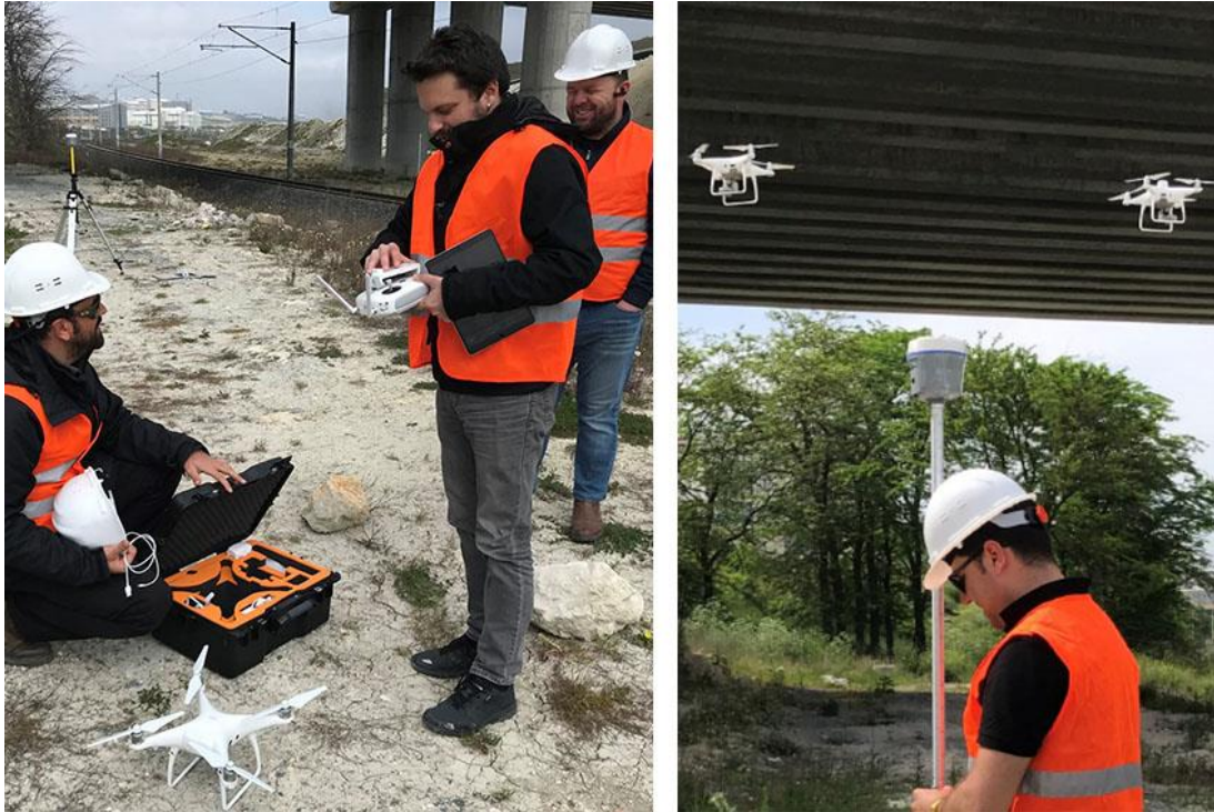
Şekil 3.32: RTK'lı ve RTK'sız modellerin ölçüm öncesi testleri.
