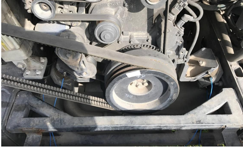
Şekil 4.3 : Motor ön bağlantı noktası için ivmeölçer yerleşimi.
