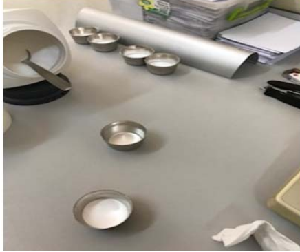
Şekil 3.9. Platin kroze numune koyma
