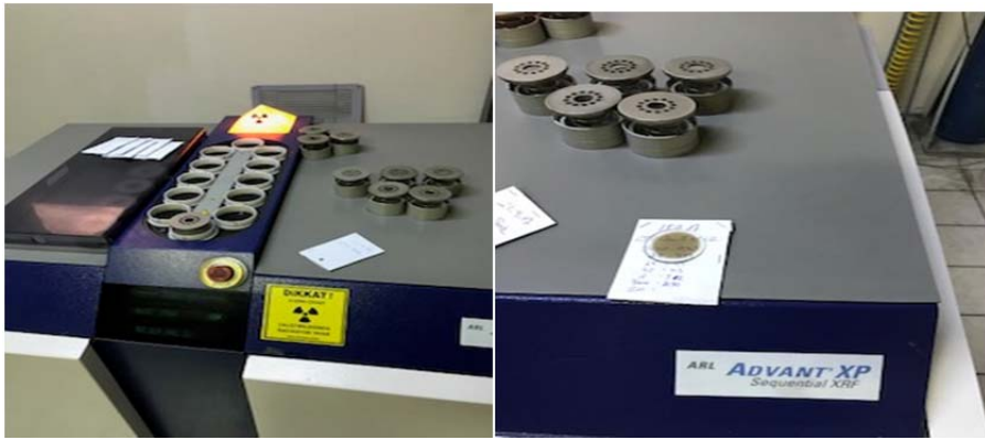
Şekil 3.8. X-Ray cihazı öncesi numune hazırlama,
