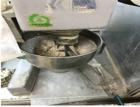
Şekil 3.4. Mikser ve basınç test dayanım cihazı
