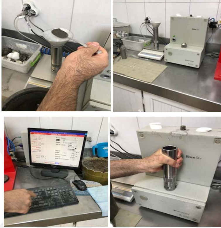
Şekil 3.1. Bulk'a numune konulması ve Blaine cihazı ile ölçüm yapılması.
