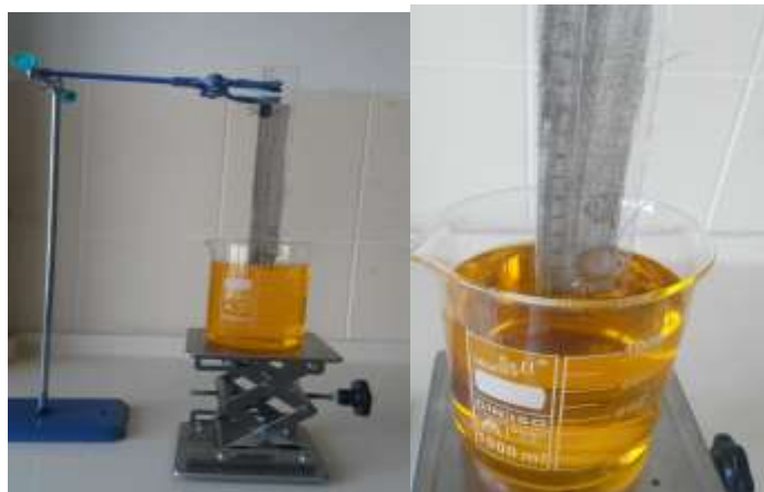
Şekil 2.9. Hidrofilite deney düzeneği
