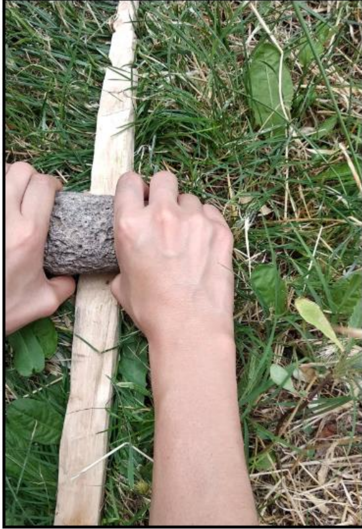
Resim 15: Bazalt kullanılarak yayın zımparalanması
