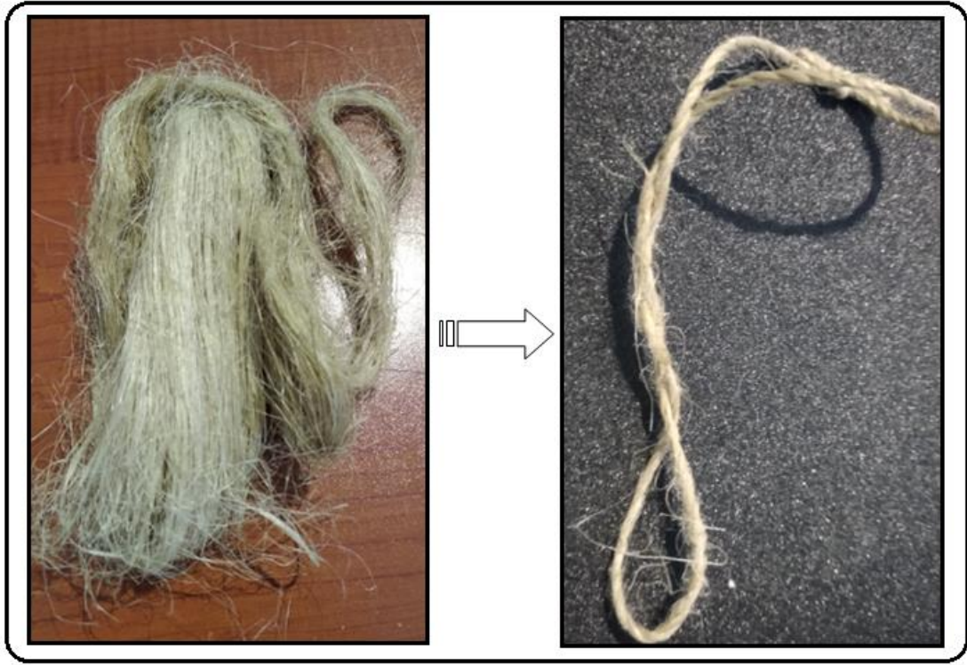
Resim 24: Kenevir lifinin ip haline getirilmesi
