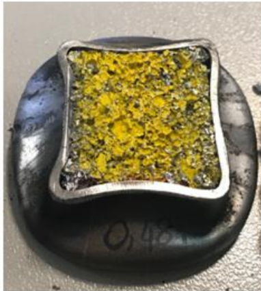
Şekil 6. 10 : 0,48 g/cm 3 yoğunluklu içi köpük dolu profilin basma testi.
