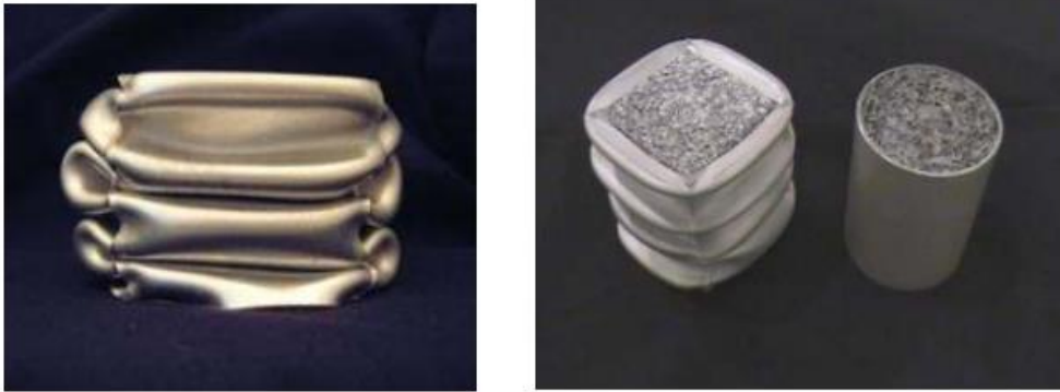
Şekil 3. 17: İçi boş ve köpük dolgulu tüpler [63].
