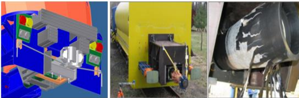
Şekil 2. 14: Geri itim kuplörü tasarımı ve test sonrası görüntüsü [33].
