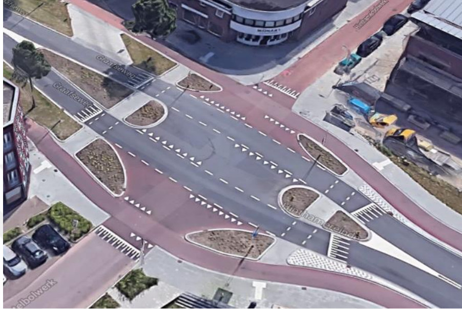
Şekil 2.19. Bisiklet yolunun sokak-cadde bağlantıları (Kırmızı yollar bisikletli ulaşımın da yapıldığı alanları ifade eder. Köpek balığı dişleri bisiklet önceliğini, piyona tuşları ise hız sınırını hatırlatır) (Anonim 2018n)
