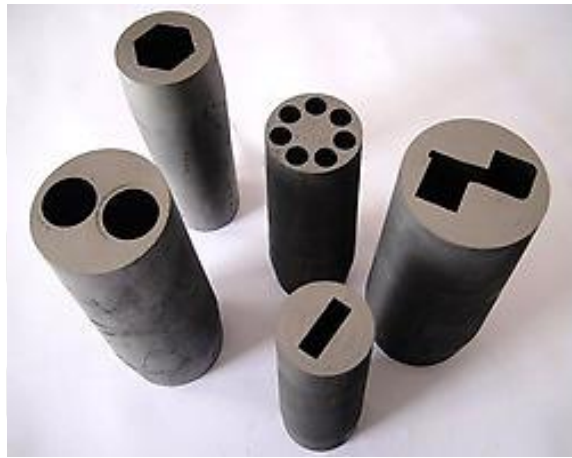
Şekil 2.14. Grafitlerin dökümde kokil kalıp olarak kullanılması. [24]
