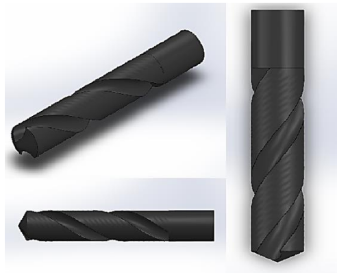
Şekil 3.3. Karbür takımın CAD görüntüsü.
