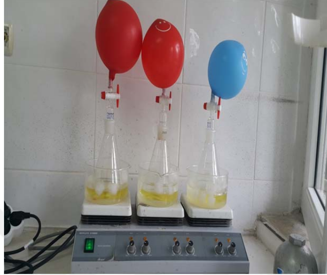
Şekil 3.6. Limon sularının sıvı-sıvı ekstraksiyon yöntemi
