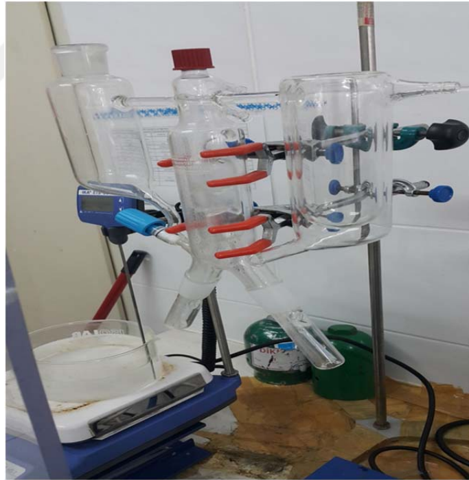
Şekil 3.7. Limon sularının SAFE yöntemi ile ekstraksiyonu
