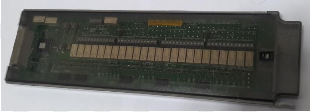
Şekil 3.17. 20 kanal kapasiteli Keysight 34901A şarter kart
