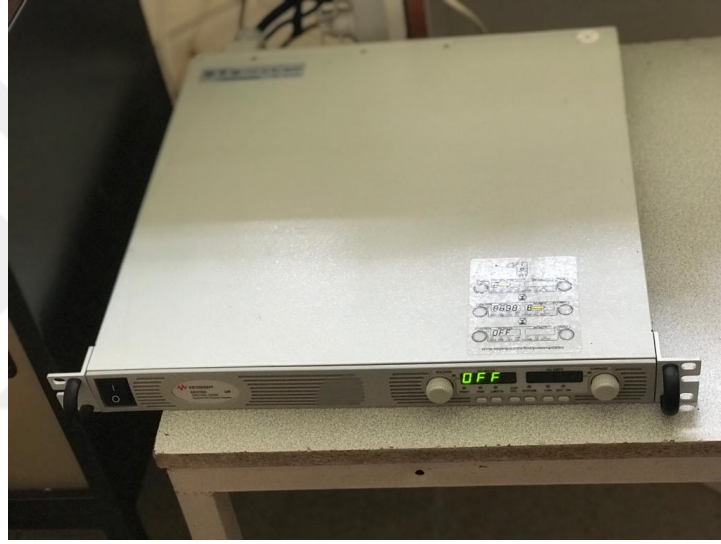
Şekil 3.19. Güç kaynağı (power supply)
