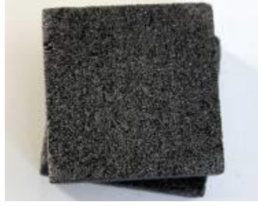
Şekil 3.1. POCO firması tarafından üretilen gözenekli grafit malzeme
