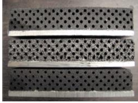
Şekil 3.11. Yukarıdan aşağıya ortalama gözenek çapları 600 \mu\text{m} , 650 \mu\text{m} , 500 \mu\text{m} (Garrity et al. 2010)
