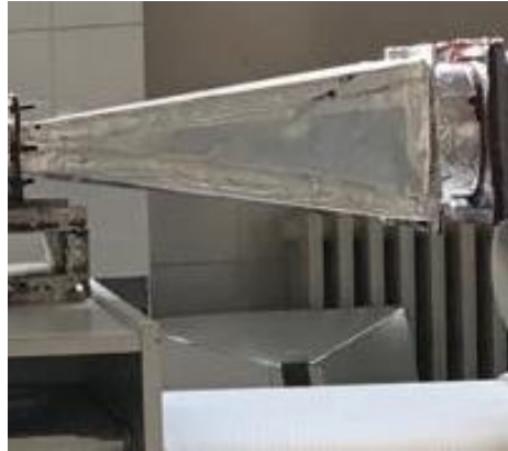
Şekil 3.6. Fan ile ısıtıcı bağlantı aparatına ait bir fotoğraf
