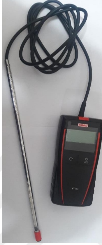
Şekil 3.20. Anemometre (Hız ölçüm cihazı)
