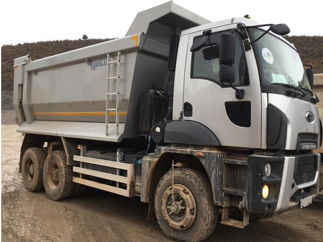
Şekil 2.8 : Yol verisi toplamak için kullanılan 6x4 inşaat test kamyonu.
