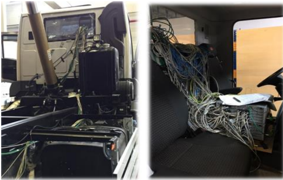
Şekil 2.11 : İvmeölçer kablolarının araç üzerinde rotalanması.
