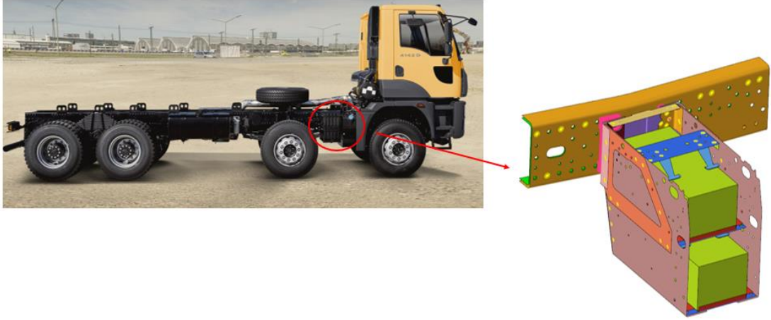
Şekil 3.1 : Bir inşaat kamyonunda bulunan akü sehpasının şasi üzerindeki konumu.
