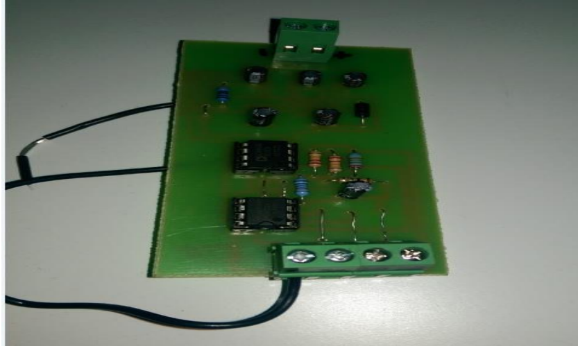
Şekil 3.35. Gerçekleştirilen EKG devresi.
