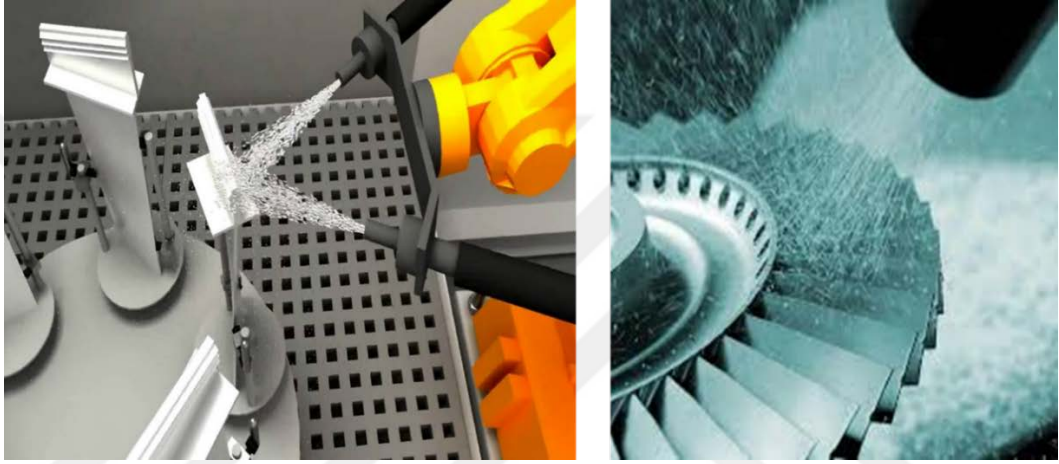
Şekil 2.3: Bilyalı Dövme Uygulaması
