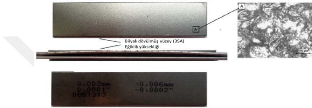
Şekil 3.3: Bilyalı Dövmüş Yüzey ve Eğiklik Görünümü
