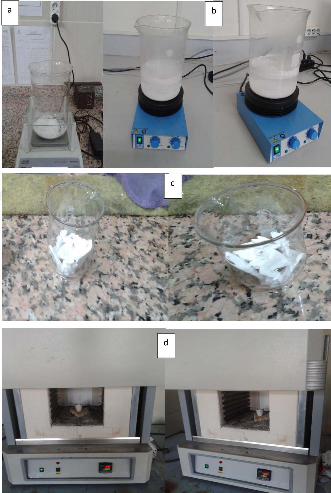
Şekil 3.11 Y_2O_3 tozlarının Al_2O_3 ile kaplanması(a: Tozların tartılması; b: Tozların manyetik karıştırıcıda karıştırılması; c: Jelleşmiş numune örnekleri; d: Fırında sinterleme işlemi)
