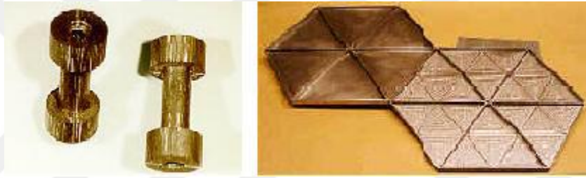
Şekil 2.9 Karbon fiber katkılı Mg matrisli kompozit uydu destek parçaları[13]
