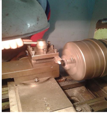
Şekil 3.25 XRD analizi için numune kesimi
