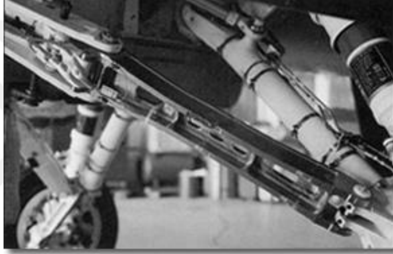
Şekil 2.12 Titanyum matrisli F-16 iniş takımları[13]
