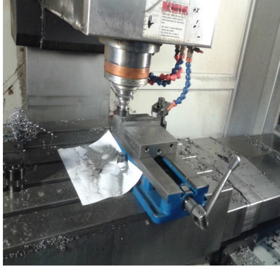
Şekil 3.20 Sertlik ölçümleri için 10x10x10 mm numune kesimi
