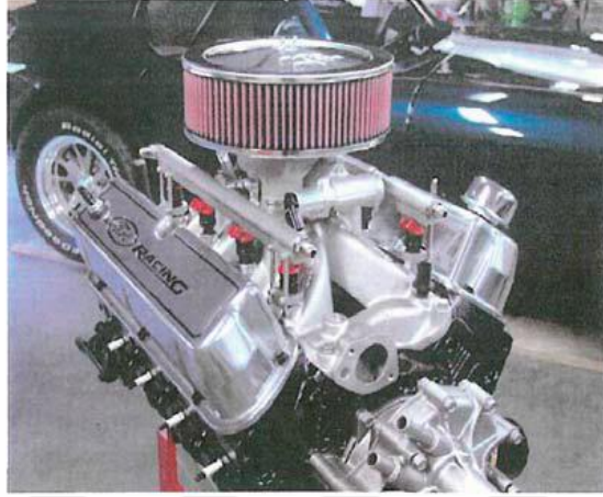
Şekil 2.26 Yüksek oranda alüminyum kullanılarak üretilmiş yüksek performanslı bir motor[24]
