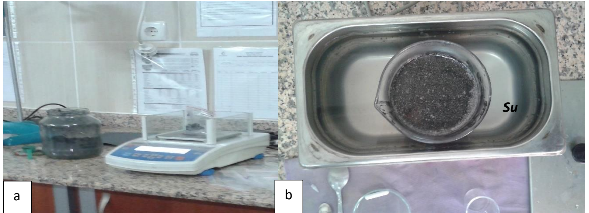
Şekil 3.3 B 4 C tozunun temizlenmesi işlemi (a: B 4 C tozunun hassas terazide tartılması; b: Ultrasonik banyoda behere konan aseton içerisinde ultrasonik temizleme işlemi)
