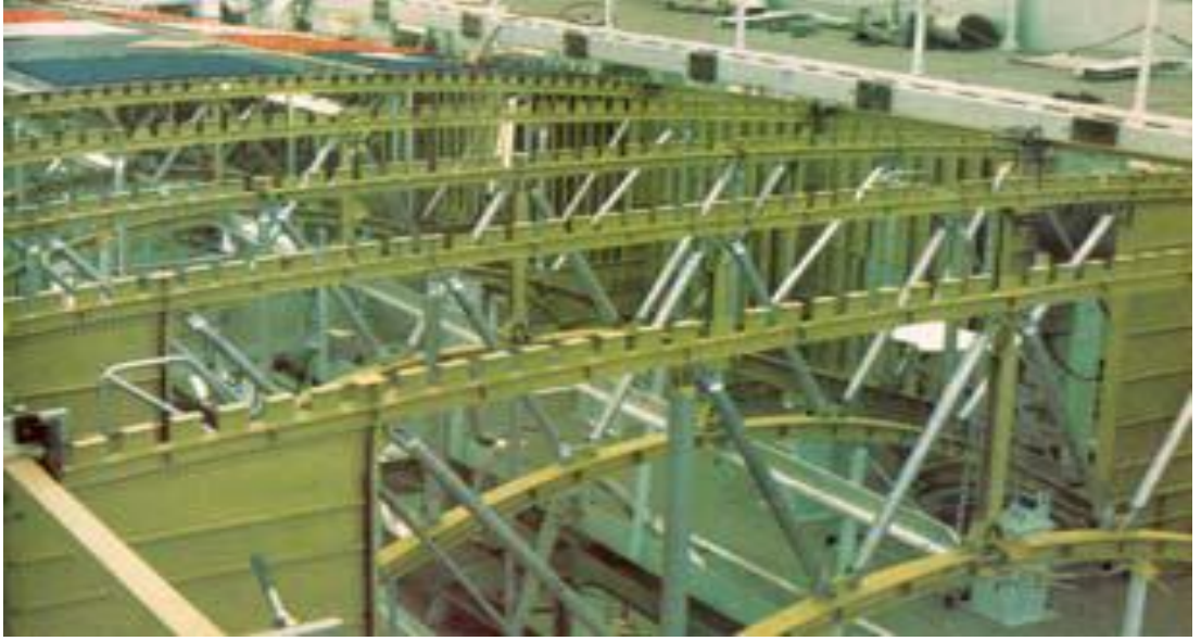
Şekil 2.8 Uzay mekiği gövdesinde kullanılan bor fiber takviyeli alüminyum tüpler[13]
