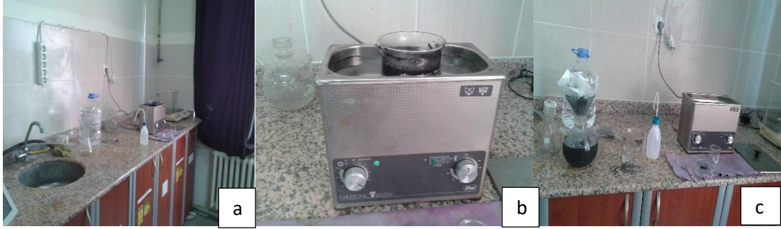
Şekil 3.5 B 4 C tozunun aktivasyon işlemi[a: B 4 C tozu behere konan ve PdCl 2 (paladyum klorür), HCl (hidro klorür) ve saf su içeren çözelti içerisine ilavesi; b: Karışım ultrasonik banyo içerisinde; c: tozlar süzülde ve saf su ile durulanarak oda sıcaklığında kurutmaya bırakıldı]
