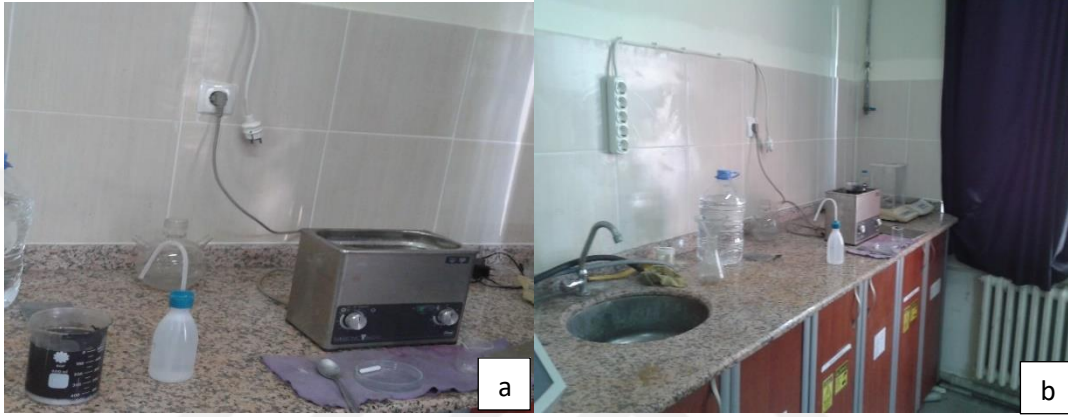
Şekil 3.4 B 4 C tozunun duyarlaştırılması işlemi[a: B 4 C tozunun behere konan SnCl 2 .H 2 O(kalay klorür monohidrat), HCl(hidro klorür) ile saf su içeren bir çözeltiye ilavesi; b: B 4 C tozu ile SnCl 2 .H 2 O(kalay klorür monohidrat), HCl(hidro klorür) ile saf su içeren çözelti içerisinde ultrasonik banyoda]
