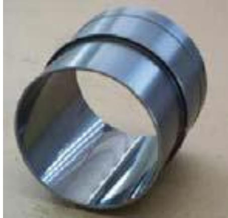
Şekil 2.10 SiC parçacık takviyeli Al metal matrisli kompozit silindir gömleği[13]
