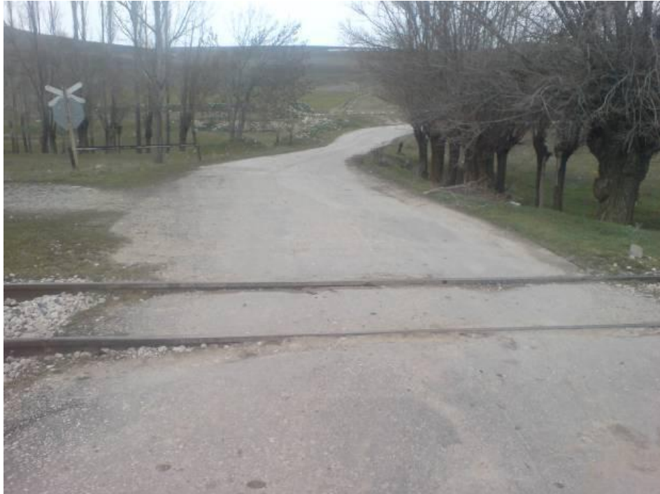
Şekil 2.15 : Asfalt kaplamalı hemzemin geçit örneği [24].
