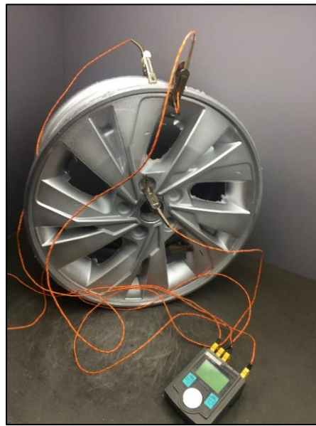
Şekil 3.20 : Fırın içi sıcaklık ölçümlerinin alındığı önemli jant bölgeleri.
