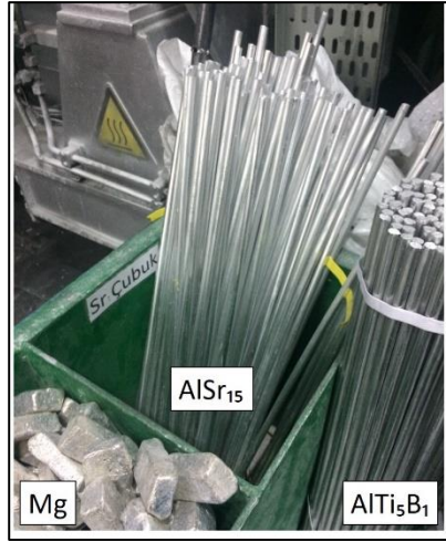
Şekil 1.9: AlTi 5 B 1 , AlSr 15 ve Mg malzeme eklentileri.
