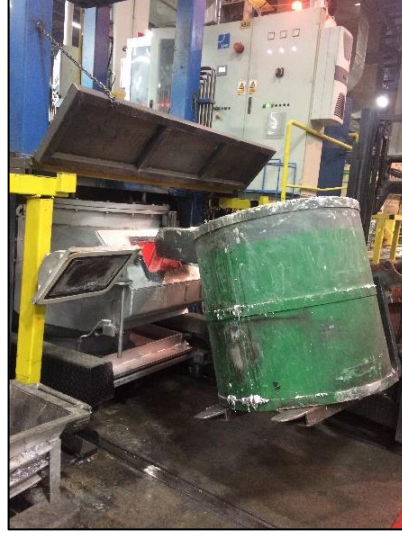
Şekil 1.11: Transfer potasından bekletme ocağına transfer.
