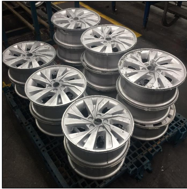
Şekil 3.19 : Alternatif malzeme (AlSi9Mg) ile dökülen jant örnekleri.
