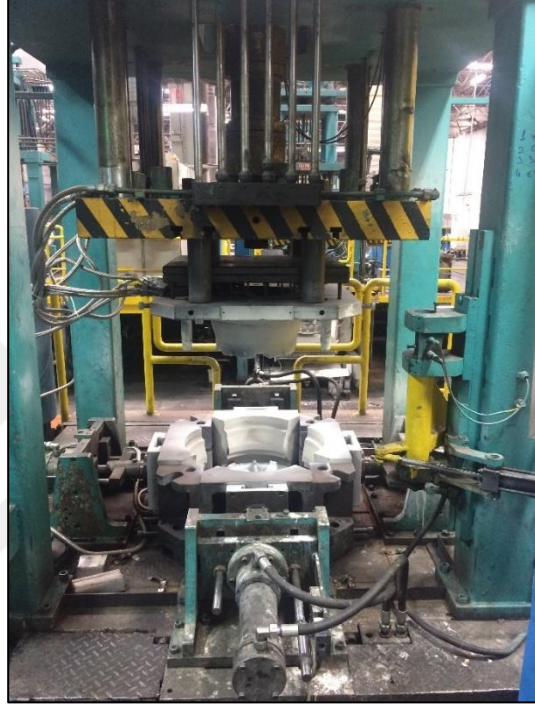
Şekil 3.18 : Kalıp hazırlığı ve deneme döküm başlangıcı.
