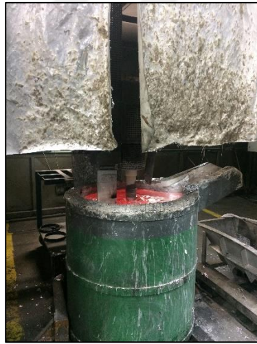
Şekil 1.10: Azot (N) gazı vererek gaz giderme süreci.
