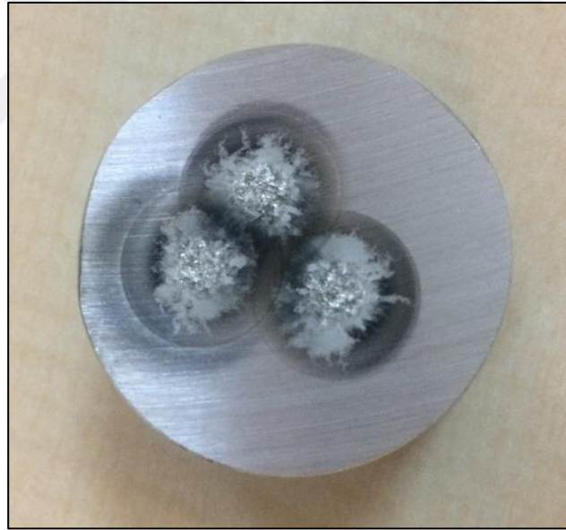
Şekil 2.1: Kimyasal içeriği ölçülen numune örneği.
