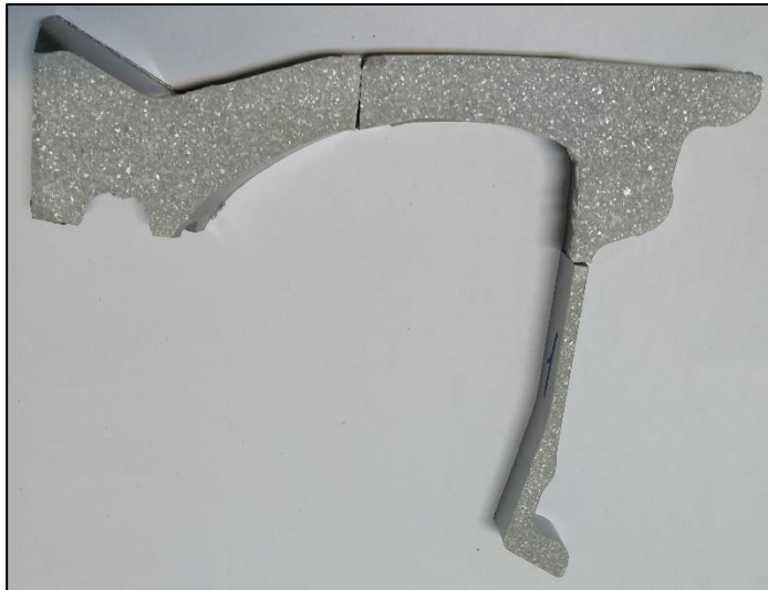
Şekil 2.7: AlSi9Mg jant kesit mikro yapı örneği.
