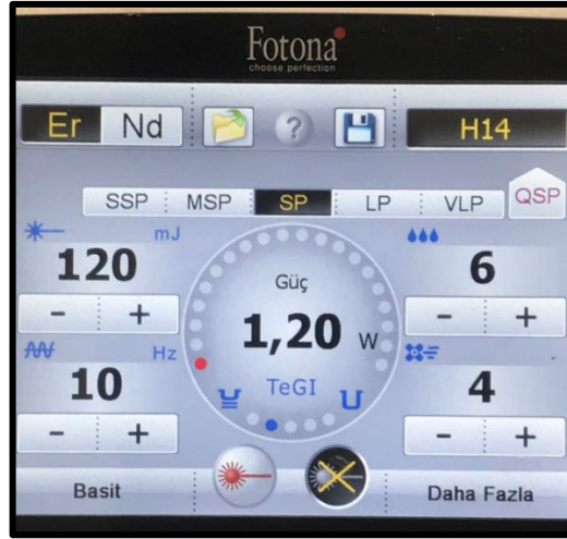
Fotoğraf 3.5: Çalışmada kullanılan lazer parametreleri
