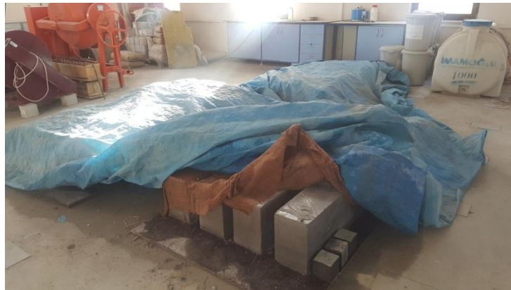
(c) Numunelerin kür edilmesi
