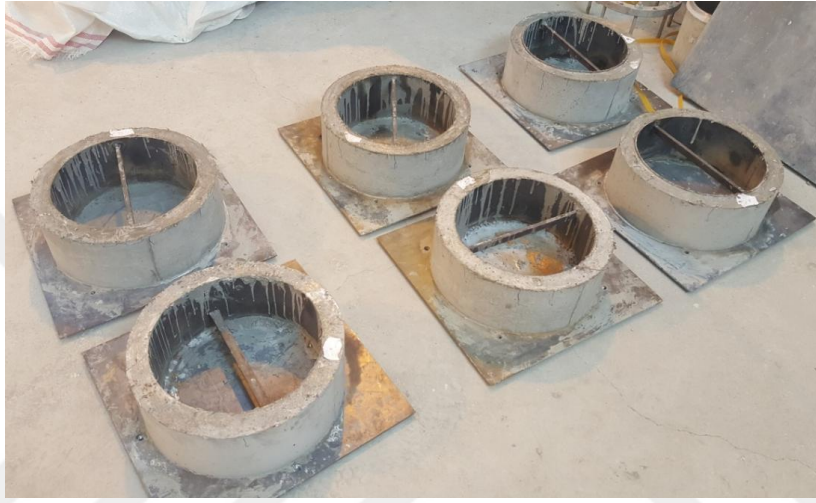
(c) Dış halkası çıkmış ve kısıtlanmış rötreye maruz bırakılan numuneler
