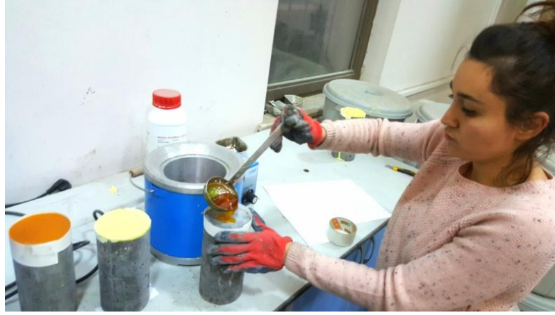
(a) Numunelere kükürt başlık yapılması
