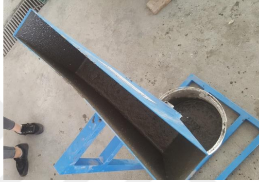
Şekil 4.22 V-hunisi deneyinde bloklanma olan MAK1_035 karışımı
