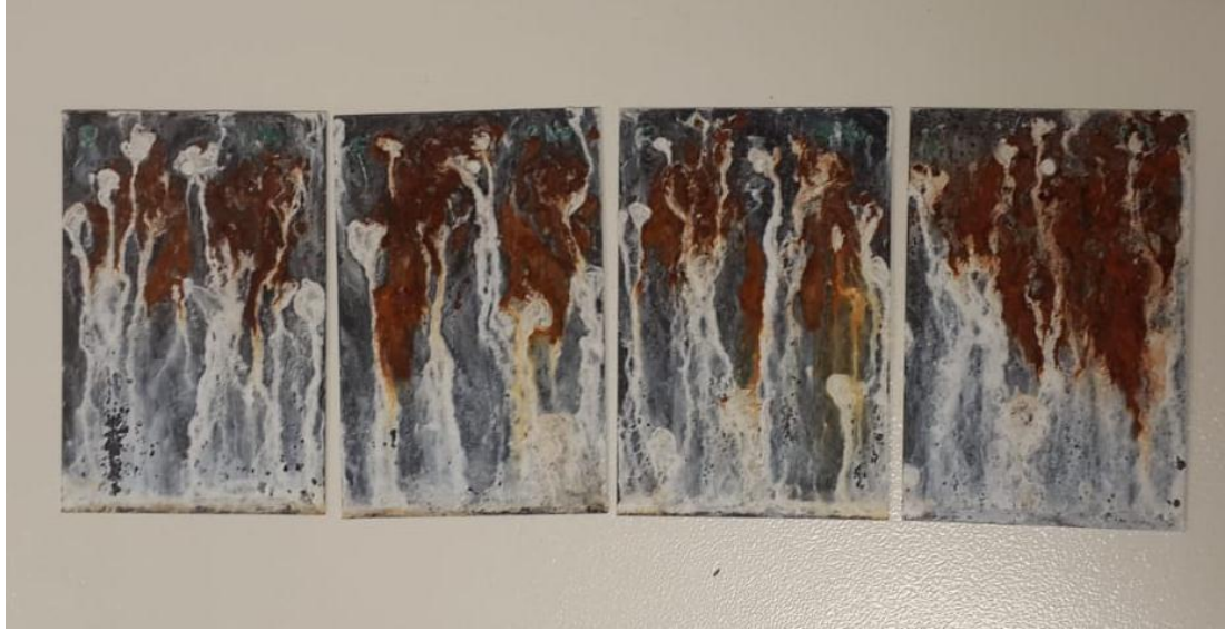
Şekil 5.13 : F seti plakalarının tuzlu su sisi testi sonrası kırmızı pas görüntüsü.
