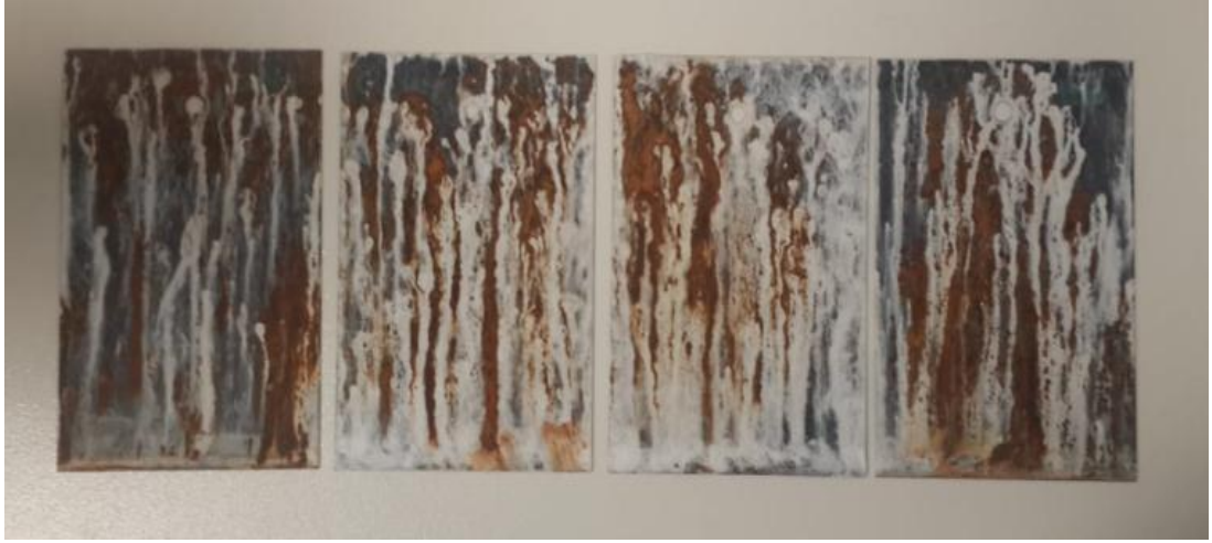
Şekil 5.23 : K seti plakalarının tuzlu su sisi testi sonrası kırmızı pas görüntüsü.
