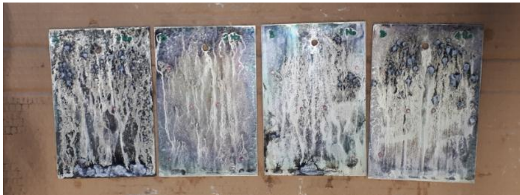
Şekil 5.4 : B seti plakalarının tuzlu su sisi testi sonrası beyaz pas görüntüsü.
