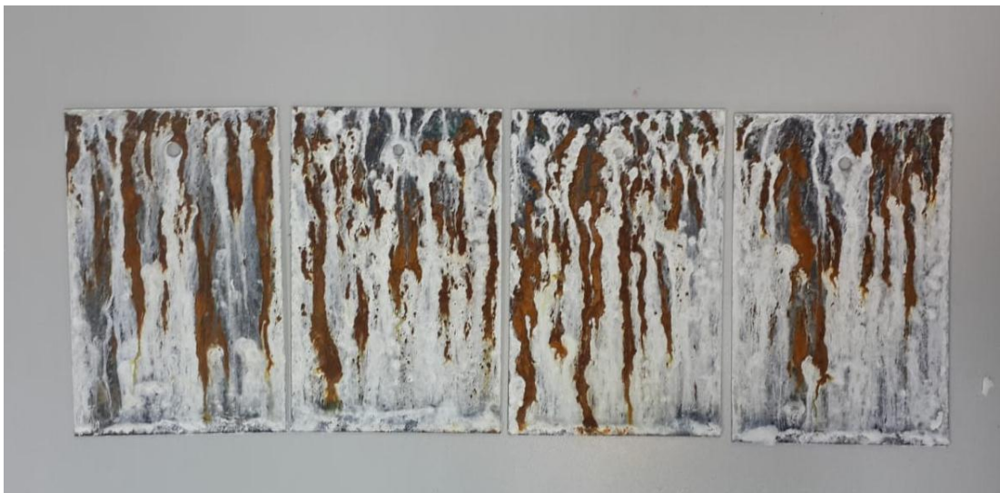
Şekil 5.17 : H seti plakalarının tuzlu su sisi testi sonrası kırmızı pas görüntüsü.
