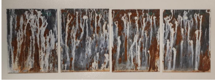
Şekil 5.19 : I seti plakalarının tuzlu su sisi testi sonrası kırmızı pas görüntüsü.
