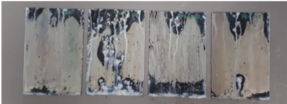
Şekil 5.2 : A seti plakalarının tuzlu su sisi testi sonrası beyaz pas görüntüsü.
