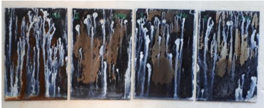
Şekil 5.20 : J seti plakalarının tuzlu su sisi testi sonrası beyaz pas görüntüsü.
