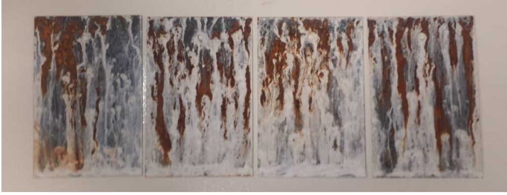
Şekil 5.21: J seti plakalarının tuzlu su sisi testi sonrası kırmızı pas görüntüsü.
