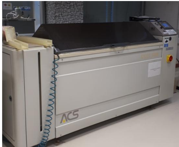
Şekil 4.6 : Korozyon kabini genel görüntüsü.
