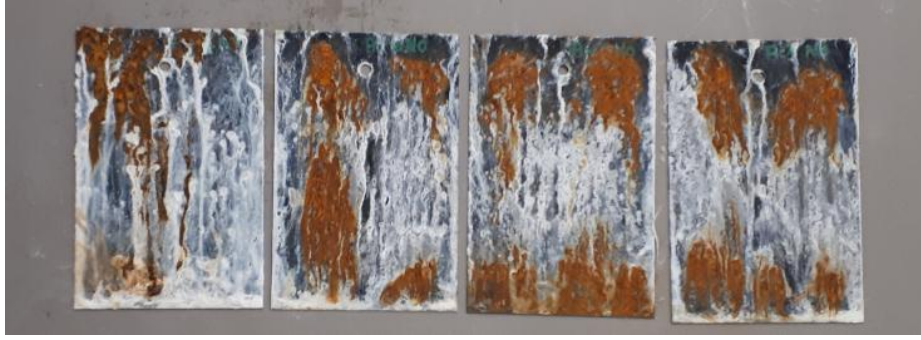
Şekil 5.3 : A seti plakalarının tuzlu su sisi testi sonrası kırmızı pas görüntüsü.
