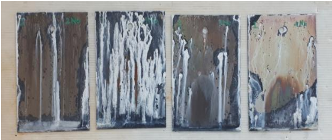
Şekil 5.18 : I seti plakalarının tuzlu su sisi testi sonrası beyaz pas görüntüsü.
