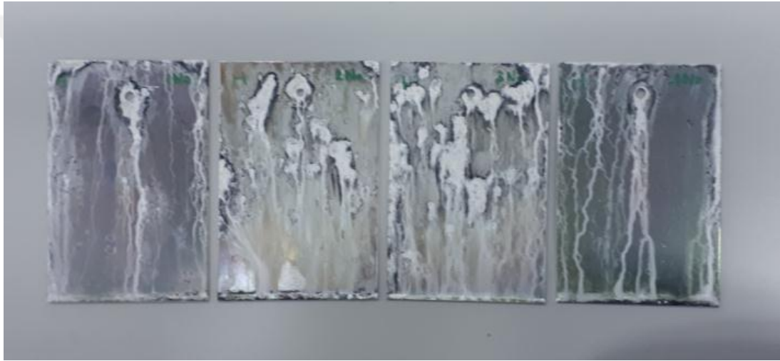
Şekil 5.16 : H seti plakalarının tuzlu su sisi testi sonrası beyaz pas görüntüsü.
