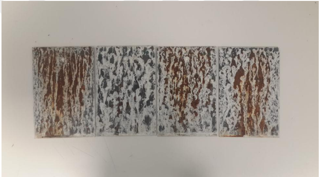
Şekil 5.7 : C seti plakalarının tuzlu su sisi testi sonrası kırmızı pas görüntüsü.
