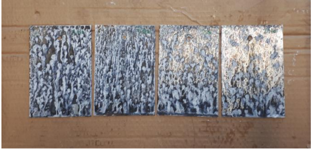
Şekil 5.6 : C seti plakalarının tuzlu su sisi testi sonrası beyaz pas görüntüsü.
