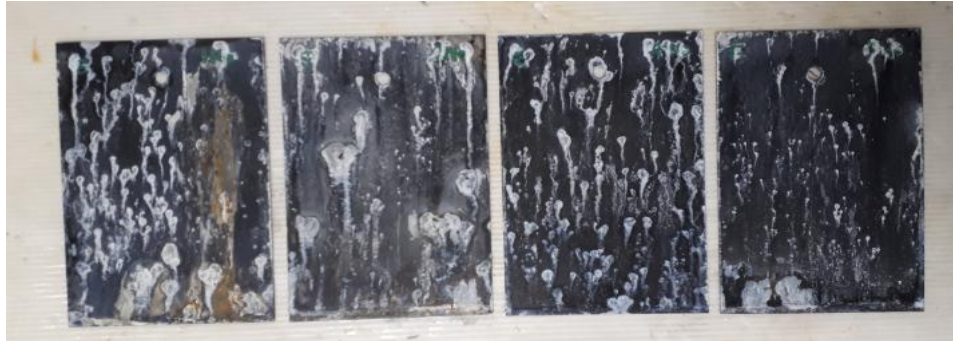
Şekil 5.10 : E seti plakalarının tuzlu su sisi testi sonrası beyaz pas görüntüsü.
