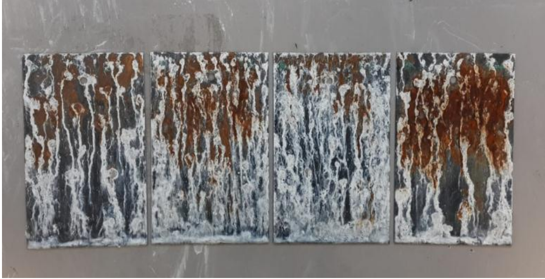
Şekil 5.5 : B seti plakalarının tuzlu su sisi testi sonrası kırmızı pas görüntüsü.
