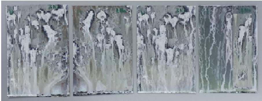
Şekil 5.22 : K seti plakalarının tuzlu su sisi testi sonrası beyaz pas görüntüsü.
