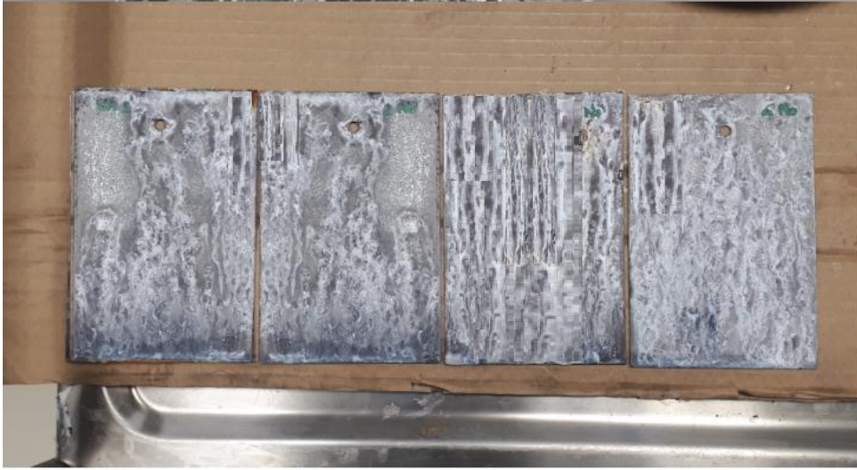
Şekil 5.14 : G seti plakalarının tuzlu su sisi testi sonrası beyaz pas görüntüsü.
