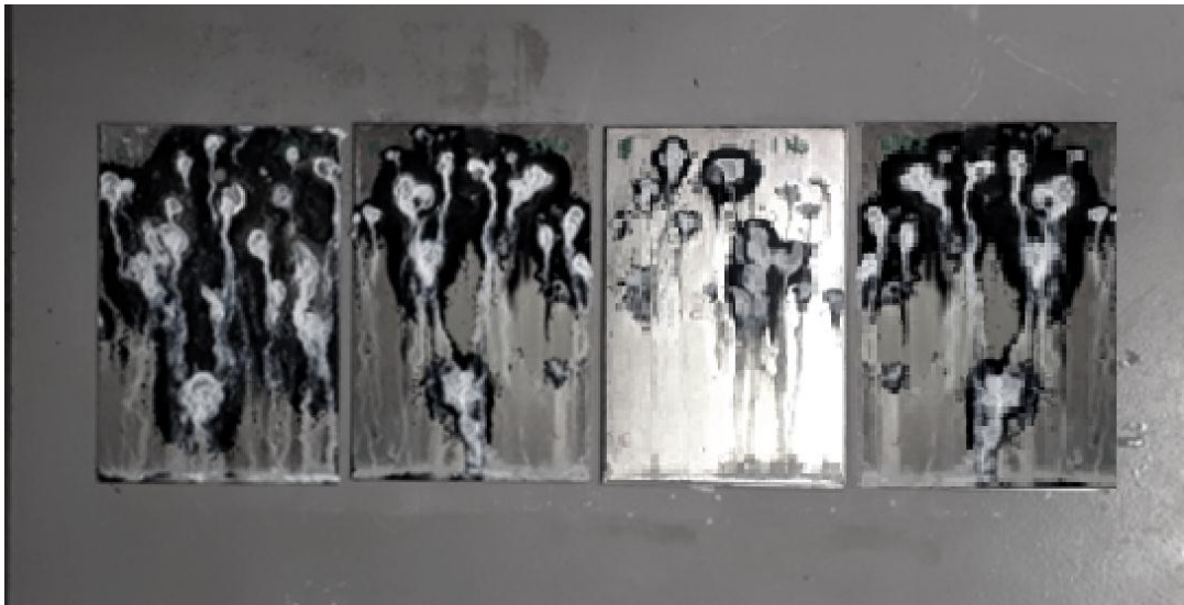
Şekil 5.12 : F seti plakalarının tuzlu su sisi testi sonrası beyaz pas görüntüsü.
