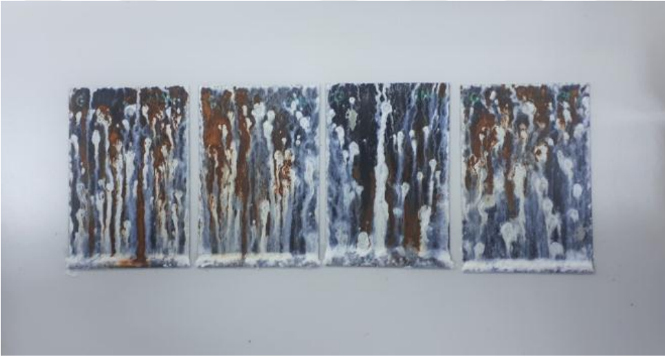
Şekil 5.15 : G seti plakalarının tuzlu su sisi testi sonrası kırmızı pas görüntüsü.
