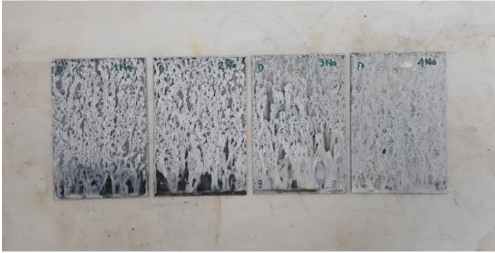
Şekil 5.8 : D seti plakalarının tuzlu su sisi testi sonrası beyaz pas görüntüsü.
