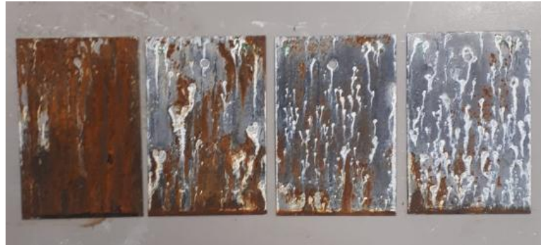
Şekil 5.11 : E seti plakalarının tuzlu su sisi testi sonrası kırmızı pas görüntüsü.
