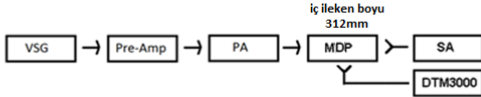
Şekil 4.17: İç iletken boyu 312 mm olan MDA prop deneme V1’in zayıflatıcı kullanılmayan deney düzeneğinin blok diyagramı.
