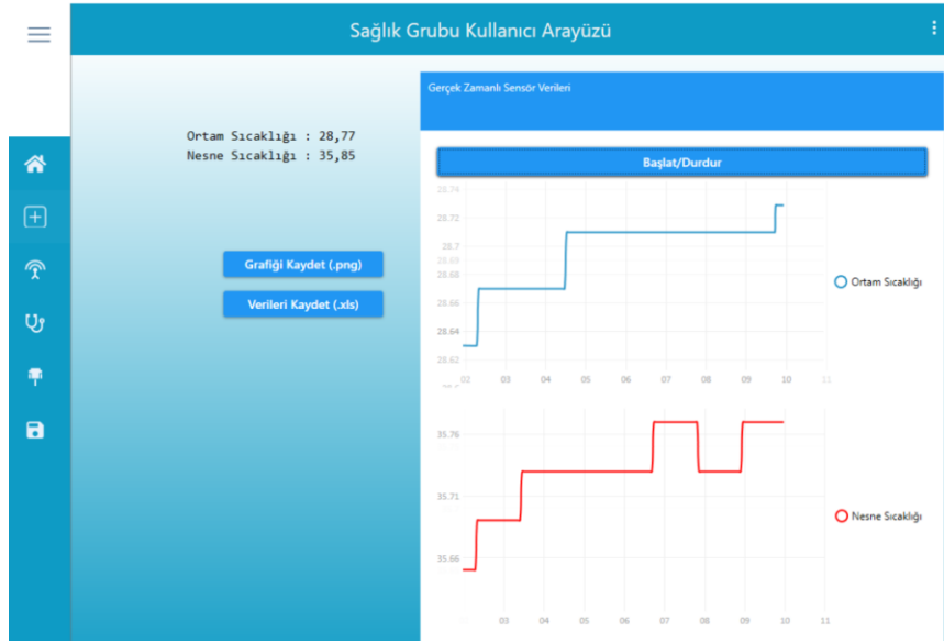
Şekil 6.9: MDA probunun kuzu ciğerinde meydana getirdiği sıcaklık değişiminin mikroişlemci tabanlı kızılötesi sıcaklık sensörü kullanılarak gerçek zamanlı ölçümü.
