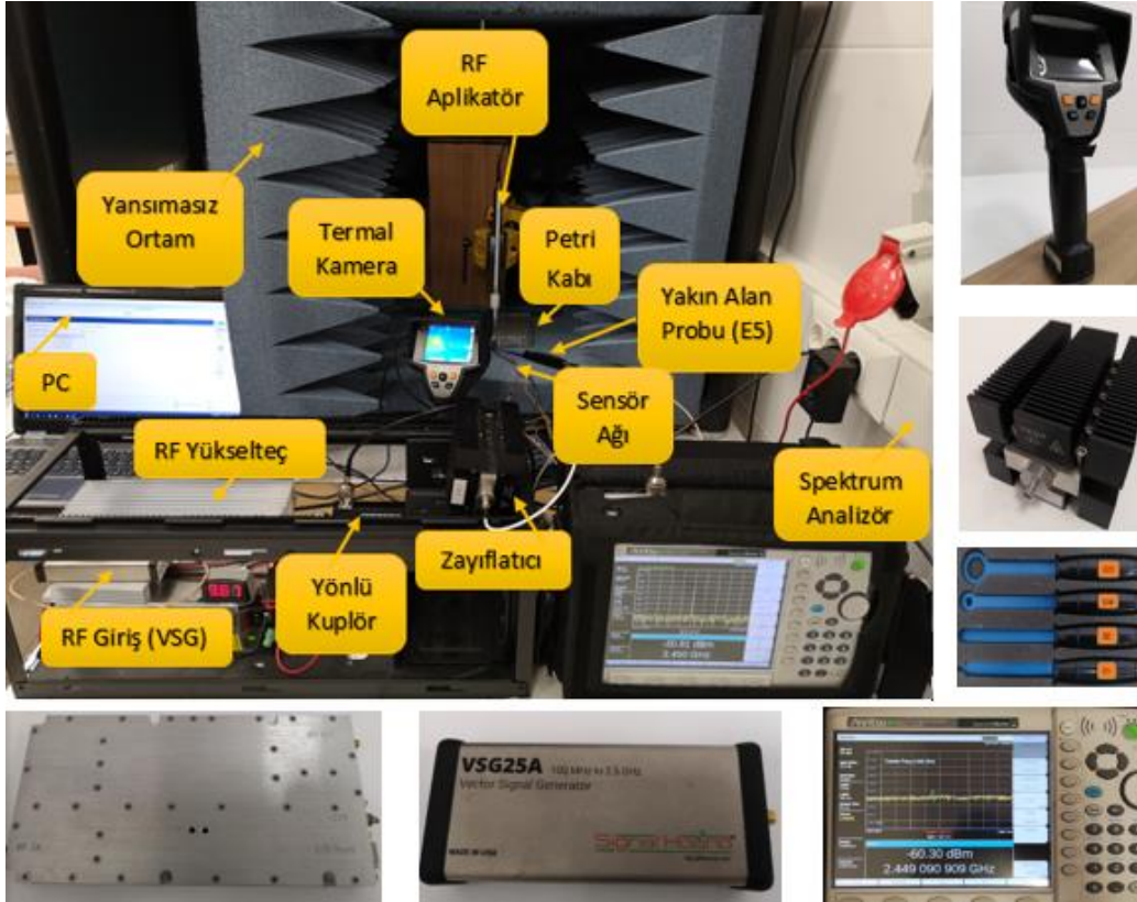
Şekil 4.22: MDA probunun elektromanyetik ışınma performansının test düzeneği.
