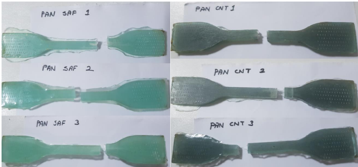
Resim 5.20-a. Çekme testi sonucunda polimer takviyeli kompozit malzemeler
