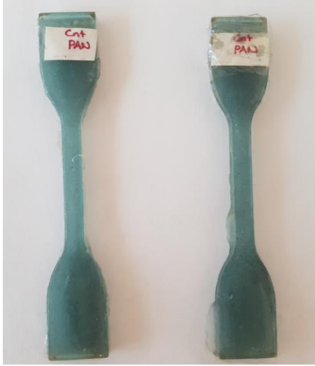
Resim 4.10-b. Köpek kemiği modeli üretilen kompozit malzeme
