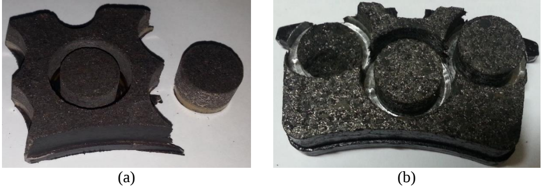
Şekil 4.23. Ticari ön fren (a) ve arka fren (b) balata numunelerinin fotoğrafı
