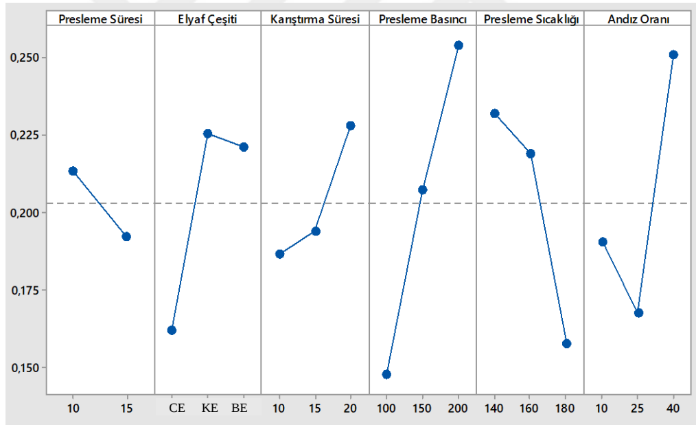
Şekil 4.9. Aşınma oranı için faktörlerin temel etki grafiği
