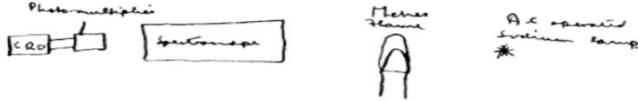
Şekil 2.3. 1952 yılında Walsh tarafından hazırlanan raporda belirtilen atomik absorpsiyon ölçüm düzeneğinin ilk taslağı (Welz ve Sperling, 1976: 26-32).
