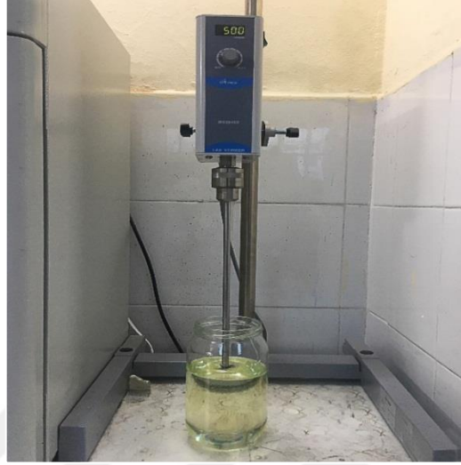
Şekil 3. 3. Epoksi sisteminin mekanik karıştırıcı ile karıştırılması
