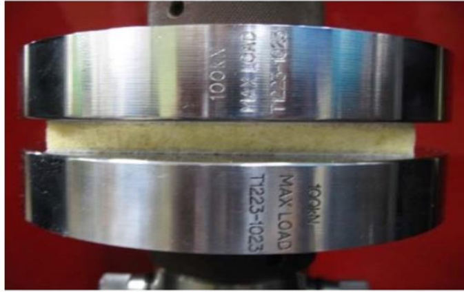
Şekil 2. 19. Basma yükü altında PUF çekirdek esaslı sandviç numunesi (Abdi et al. 2016)
