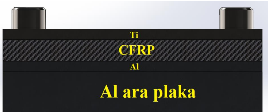
Şekil 4.9 : İkinci istif sırası (CFRP/Al/Ti).
