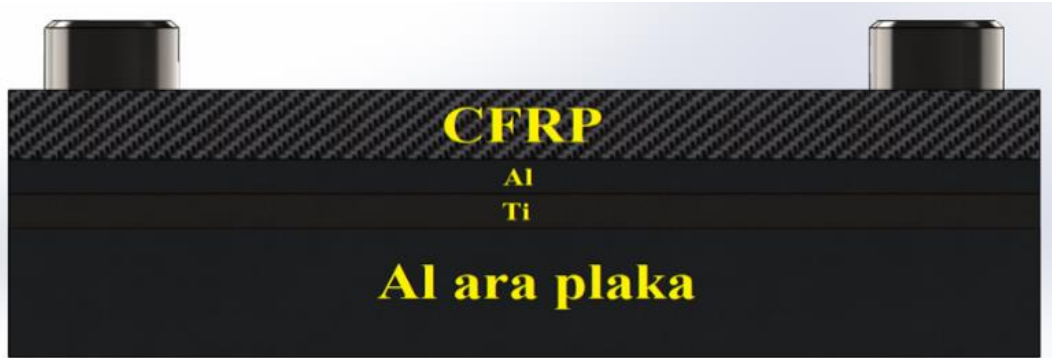
Şekil 5.3 : İkinci istif sırası (CFRP/Al/Ti).
