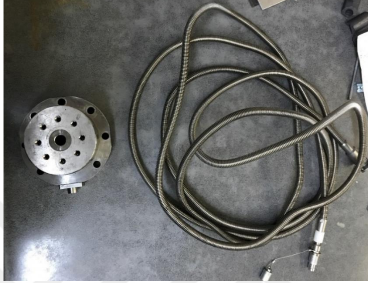
Şekil 4.2 : Kistler markalı 9272 dahili yükselticili dinamometre ve 16xx yüksek dirençli bağlantı kablosu.
