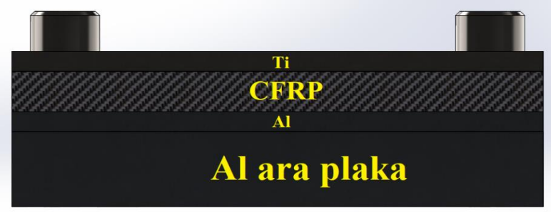
Şekil 5.5 : Üçüncü istif sırası (Ti/CFRP/Al).
