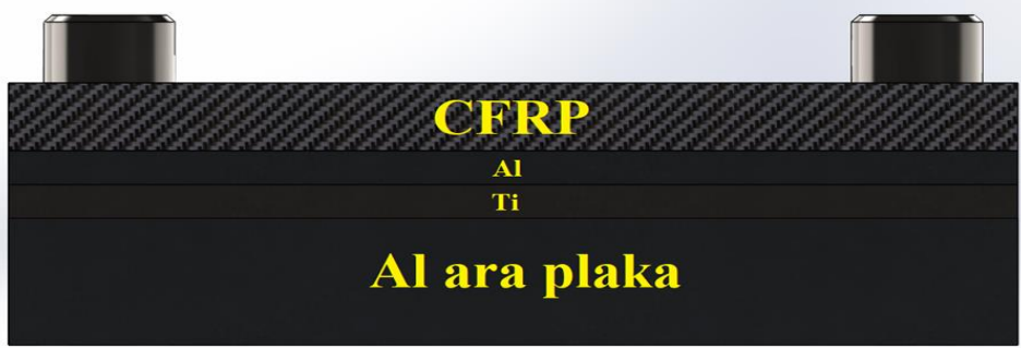
Şekil 4.9 : İkinci istif sırası (CFRP/Al/Ti).
