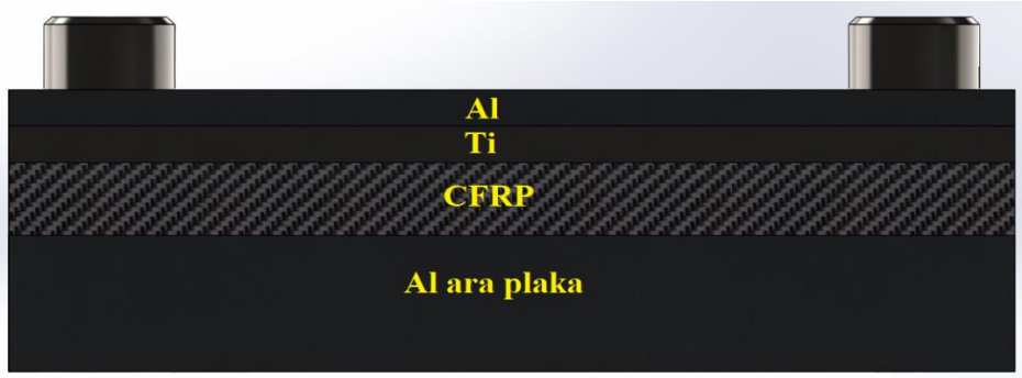
Şekil 4.8 : İlk istif sırası (Al/Ti/CFRP).
