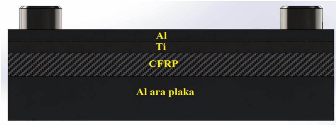
Şekil 5.1 : İlk istif sırası (Al/Ti/CFRP).
