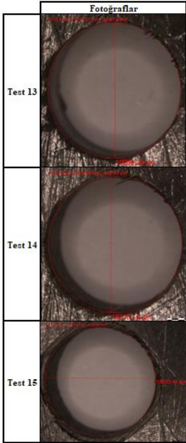
Şekil 5.38 : Üçüncü istif sırasında (Ti/CFRP/Al) çıkış delik yüzeyleri.
