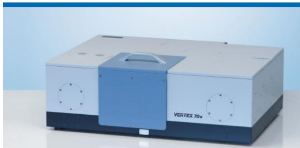
Şekil 3.7. Fourier dönüşümlü kızılötesi (FTIR) spektroskopisi
