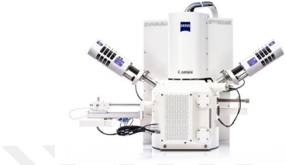
Şekil 3.6. Taramalı elektron mikroskobu (SEM)
