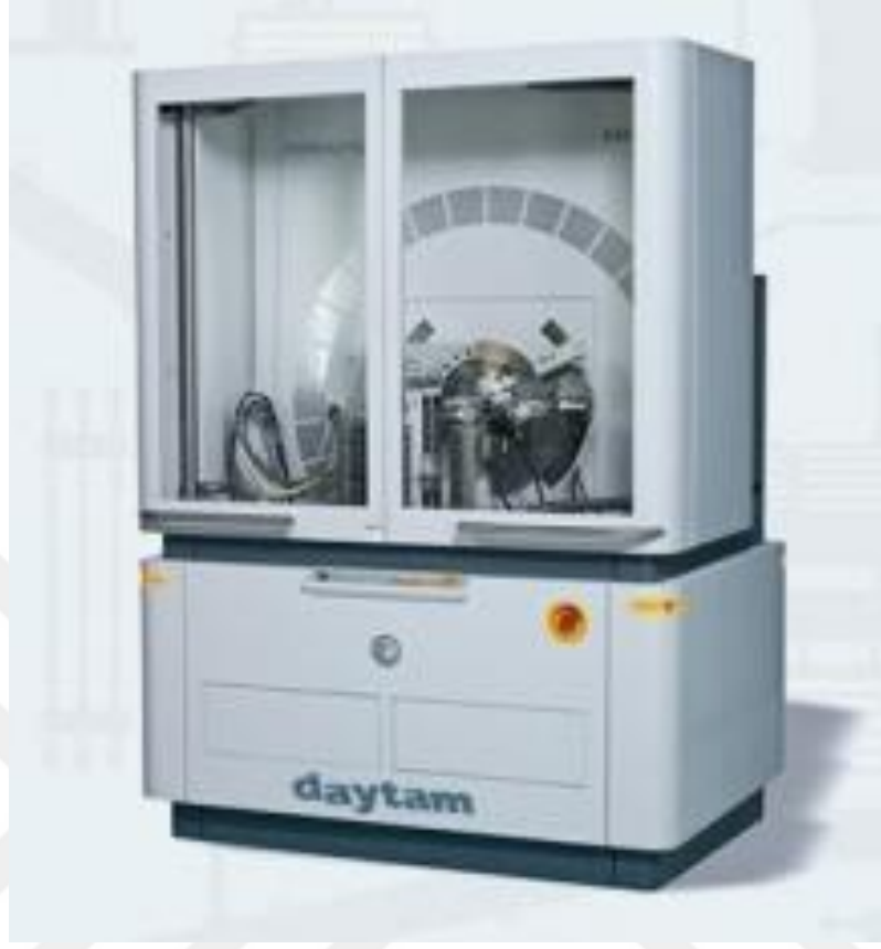
Şekil 3.5. X-Işını difraktometresi (XRD)
