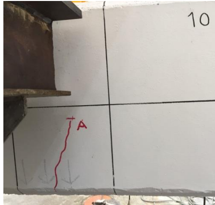
Şekil 3.18 : Numune 2a ilk eğilme çatlakları (A).
