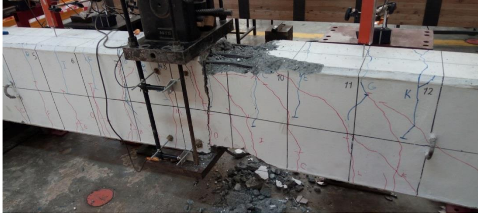
Şekil 3.25 : Numune 3 deney sonucu oluşan itme ve çekme çatlakları.
