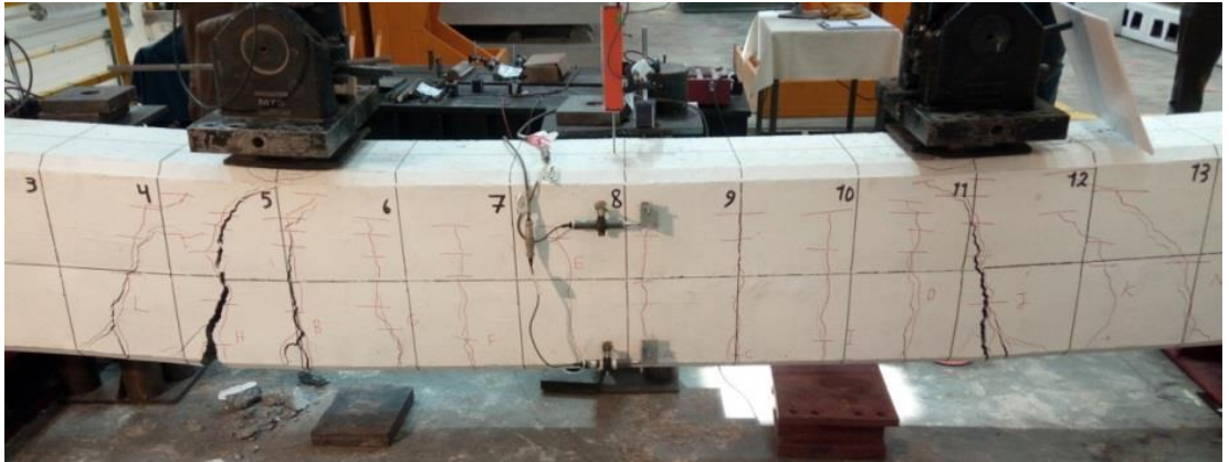
Şekil 3.21 : Numune 2b deney sonucu oluşan çatlaklar.
