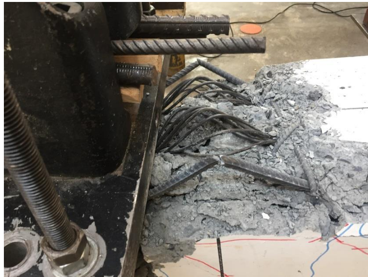
Şekil 3.27 : Numune 3 üst donatılarının burkulması.
