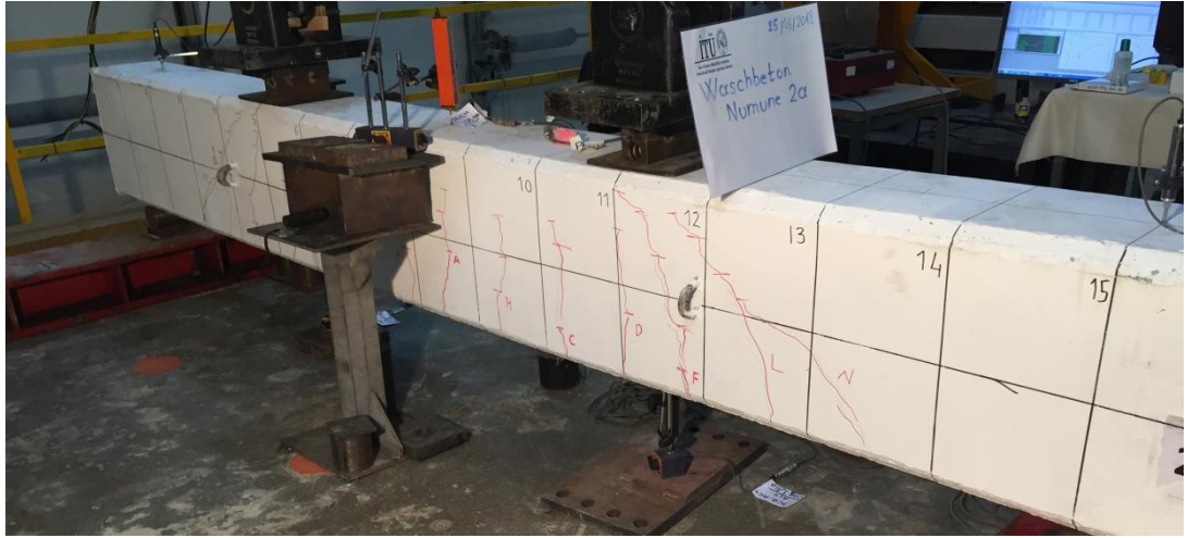
Şekil 3.20 : Numune 2a deney sonucu oluşan çatlaklar.
