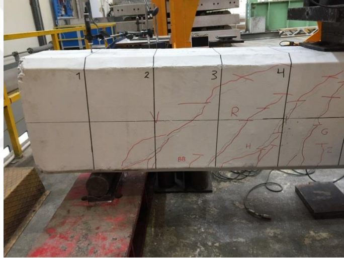
Şekil 3.14 : Numune 1 ilk kayma çatlağı (V).
