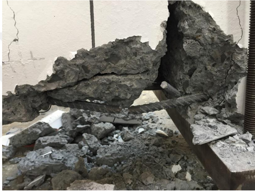
Şekil 3.26 : Numune 3 alt donatılarının kopması.
