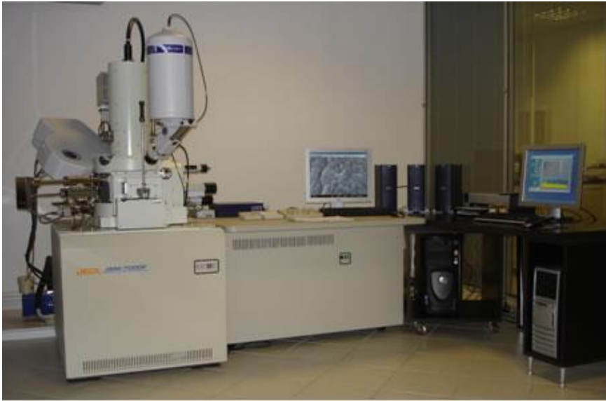
Şekil 4.8 : JEOL JSM 7000F model alan emisyonlu tarama elektron mikroskobu.
