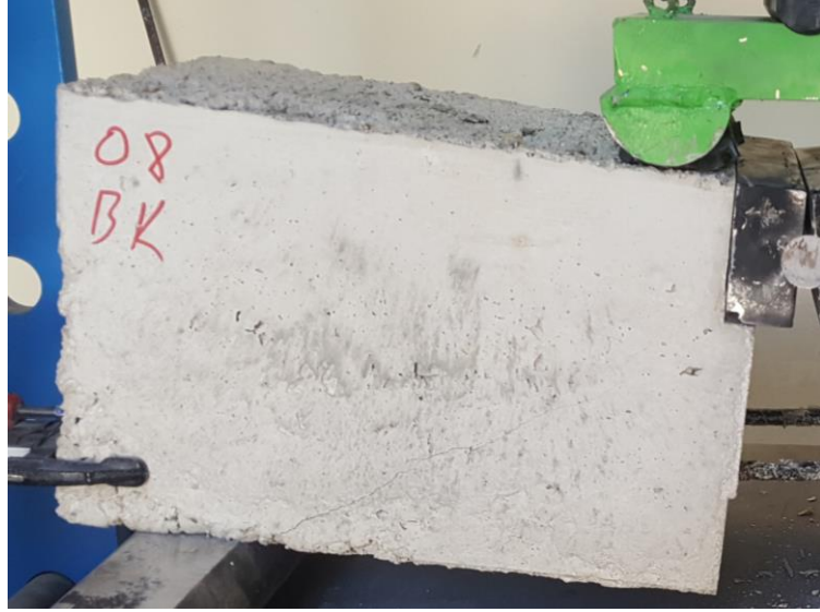
Şekil 3.22. 12 mm çapa sahip iri taneli kumlanmış ve sargılı BFRP donatılı kirişde oluşan kesme çatlağı
