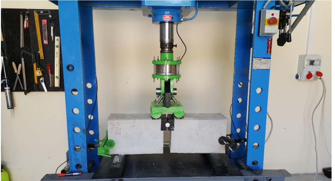
Şekil A.6. Deney kirişinin deney yükleme düzeneğine yerleştirilmesi
