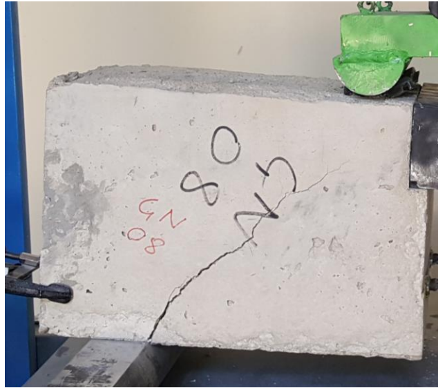
Şekil 3.20. 12mm çelik donatılı mafsallı kirişte oluşan kaldıraç etkisi
