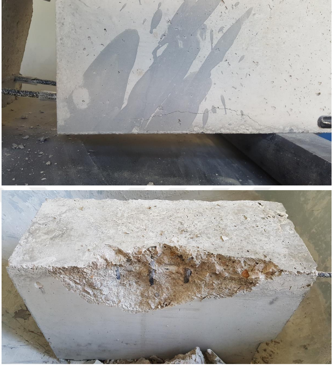
Şekil A.16. Beton ayrışma göçmesi ile sonuçlanmış bir deney kirişi
