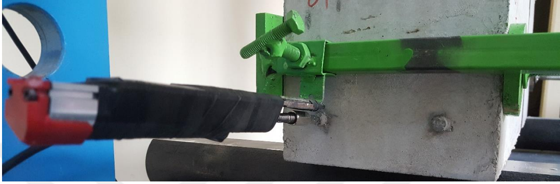
Şekil 2.16. Potansiyometrelerin kirişe sabitlenmesi
