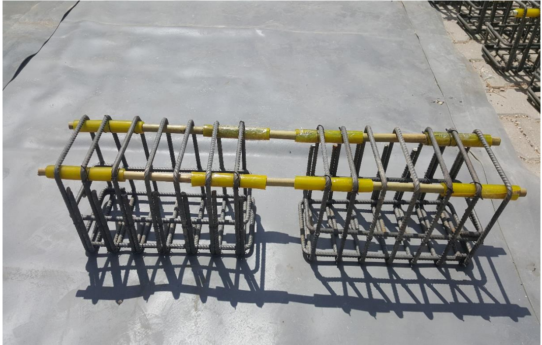
Şekil A.3. Deney kiriş donatılarının hazırlanması
