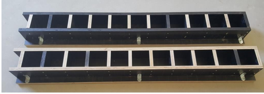
Şekil 2.5. Beton küp numune kalıpları
