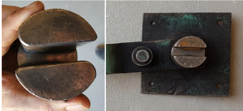
Şekil 2.6. Etriye makinesinin ve etriye kolunun büküm başlığı
