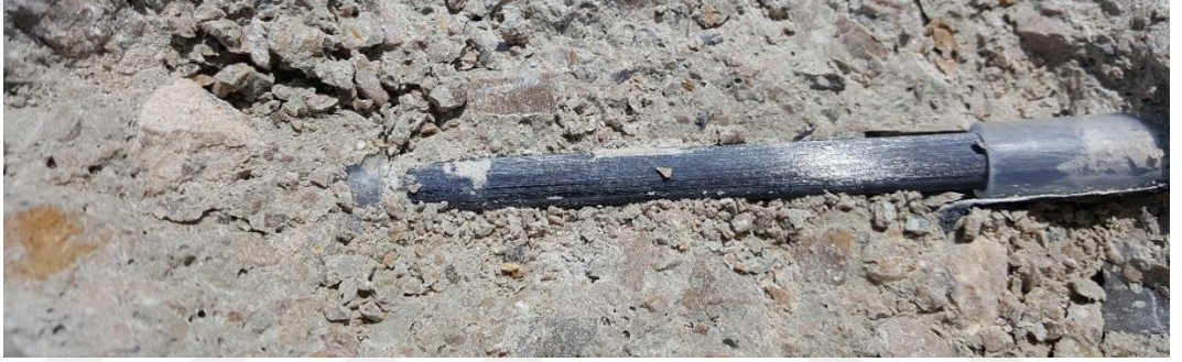
Şekil A.9. İnce taneli kumlanmış CFRP (CSf) donatının betondan sıyrılması sonrası yüzeyindeki deformasyon
