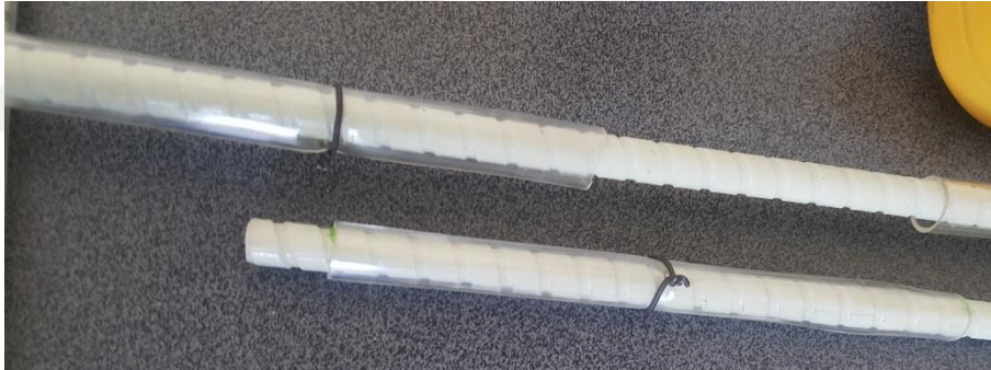
Şekil 2.8. Boyuna donatının beton ile olan temasının kesilmesi
