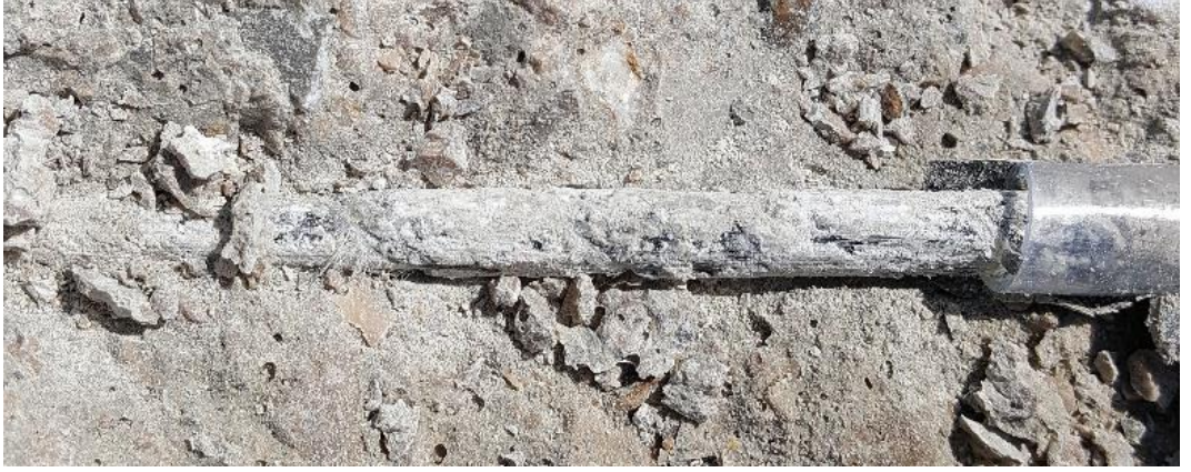
Şekil A.12. İri taneli kumlanmış ve sargılı BFRP (BWw+Sc) donatının betondan sıyrılması sonrası yüzeyindeki deformasyon
