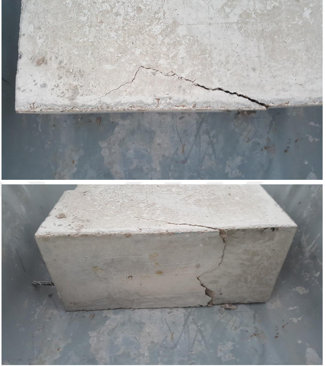
Şekil A.15. Kaldıraç etkisinden dolayı göçmüş bir kiriş numunesi
