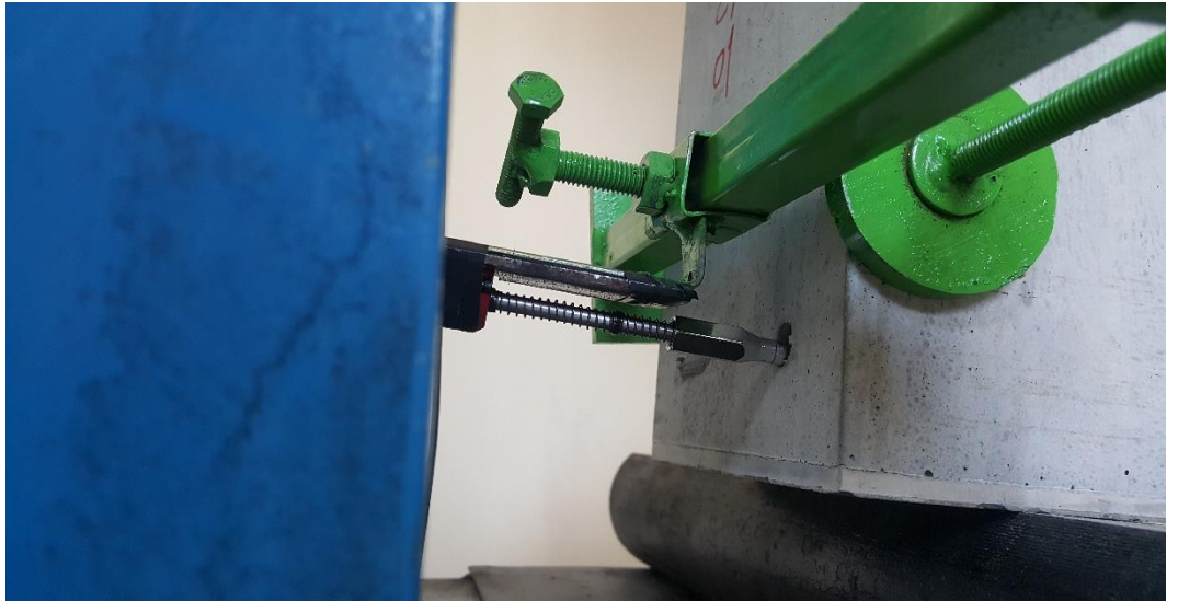
Şekil A.7. Sıyrılma göçmesiyle sonuçlanmış bir deney kirişi
