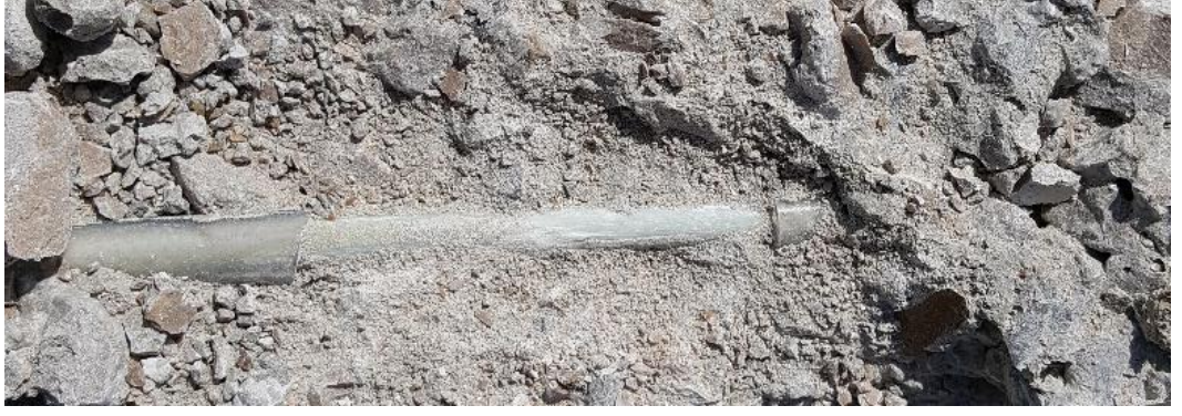
Şekil A.8. İnce taneli kumlanmış GFRP (GSf) donatının betondan sıyrılması sonrası yüzeyindeki deformasyon
