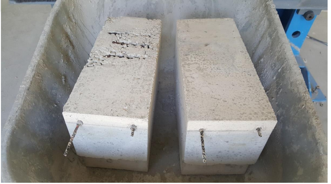
Şekil A.17. Deney kirişlerinde oluşan segregasyon
