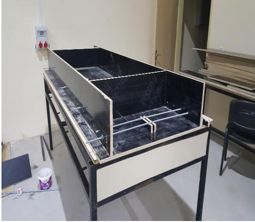
Şekil A.2. Deney kiriş kalıplarının hazırlanması
