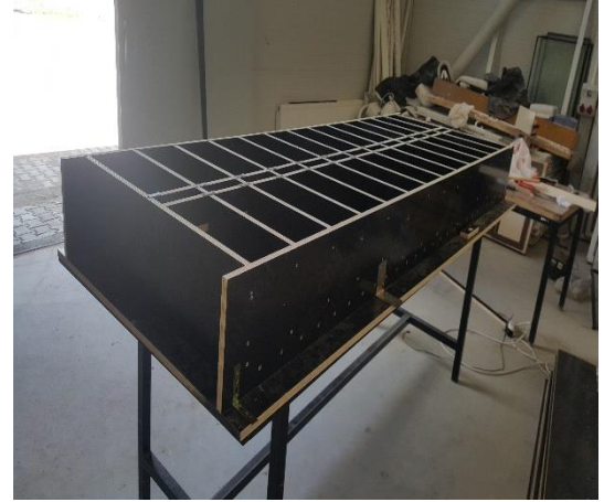
Şekil A.2. Deney kiriş kalıplarının hazırlanması
