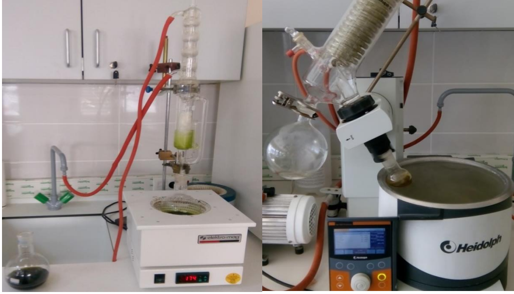
Şekil 3.2. Soxhlet cihazıyla ekstre elde etme ve evaporatörle çözücünün uçurulması
