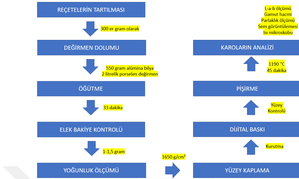
Şekil 4.1. Deney karolarının hazırlanması akım şeması
