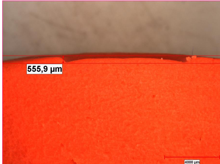
Şekil 52. 10 mm travma ucu, 250 g kuvvet, bir tekrar altında oluşturulan hamur numune travma derinliği
