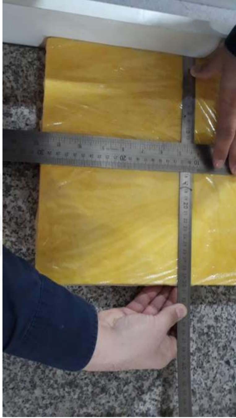
Test numunesinin ölçüsü 300*300*X mm
