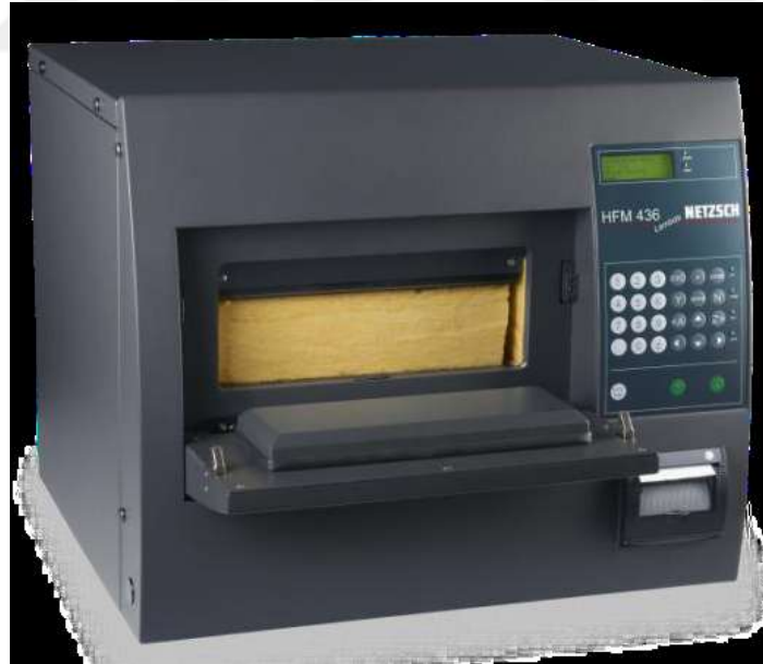
Şekil 26 Testlerin yapımında kullanılan cihazımız. NETZSCH firmasının HFM 436 modeli cihazıdır.
