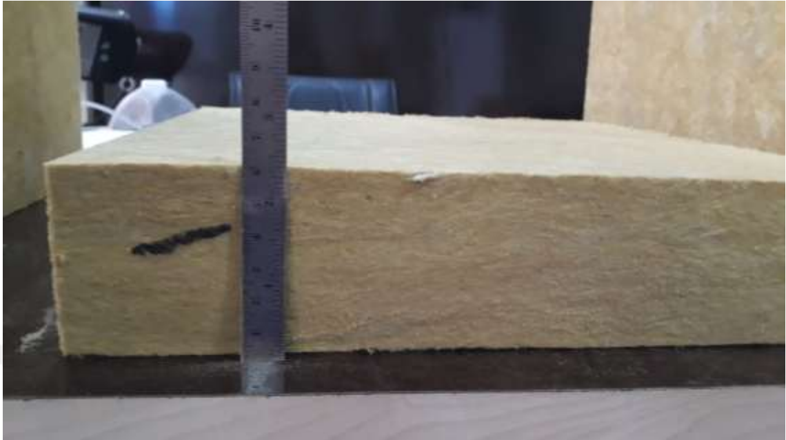
Şekil 39 60 mm 150 kg/m 3 deney numunesi
