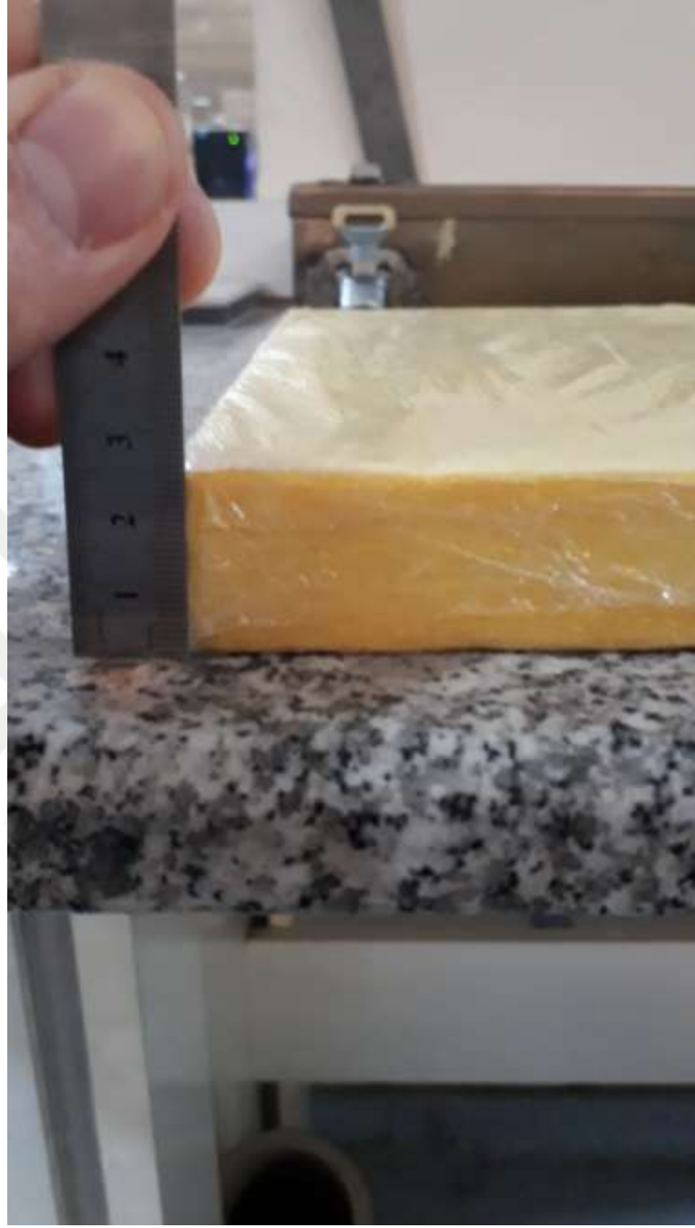
Test numunesinin kalınlığı X \times X \times 25 mm
