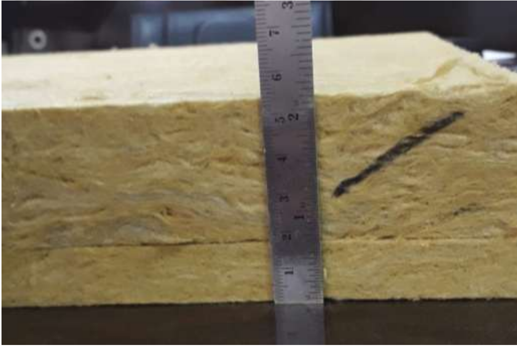
Şekil 55 40 mm 150 kg/m 3 ve 20 mm 100 kg/m 3 den oluşan deney numunesi
