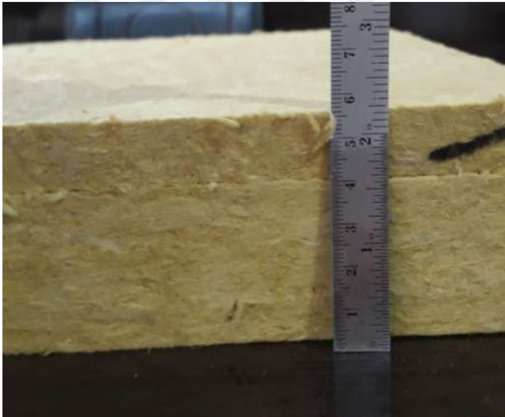
Şekil 49 20 mm 150 kg/m 3 ve 40 mm 100 kg/m 3 den oluşan deney numunesi
