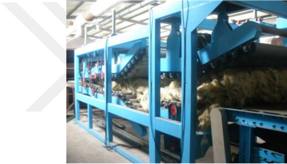
Şekil 13 Krimping_ Yumuşak elyafın sıkıştırılarak sert hale getirilmesi
