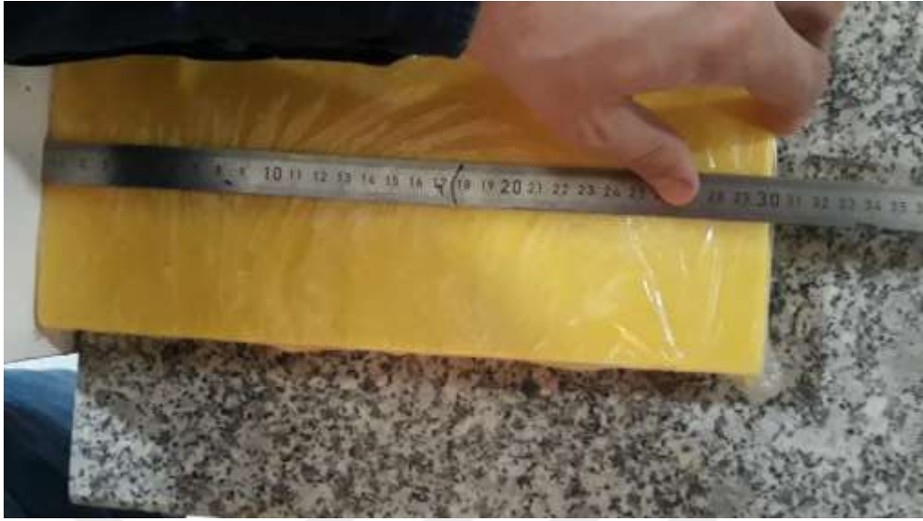
Şekil 31 Test edilen numunelerimizin boyutlarının ölçümü
