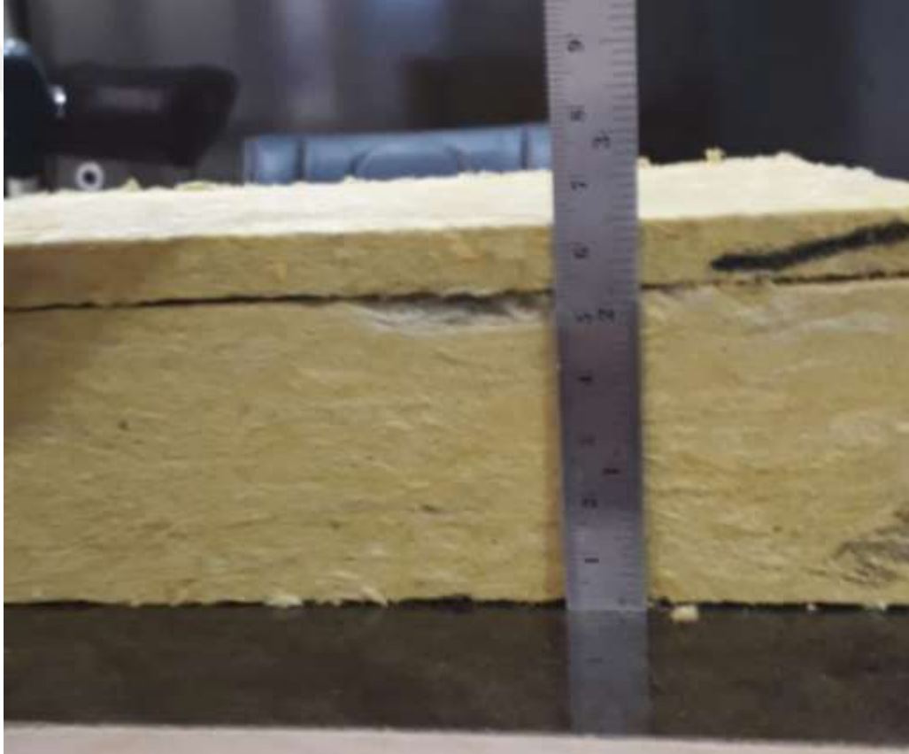
řekil 45 10 mm 150 kg/m 3 ve 50 mm 100 kg/m 3 den oluřan deney numunesi
