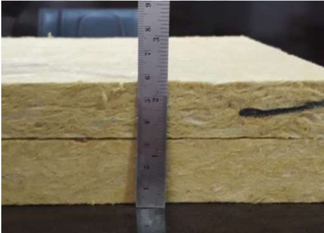
Şekil 52 30 mm 150 kg/m 3 ve 30 mm 100 kg/m 3 den oluşan deney numunesi
