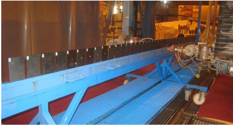
Şekil 36: Ultrasonik C-Tarama Sistemi ile Numunelerin Muayenesi
