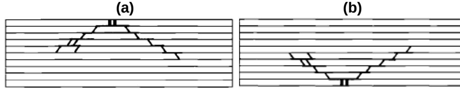
Şekil 5: (a) Kalın Plakalarda, (b) İnce Plakalarda Hasar İlerleme Şekilleri
