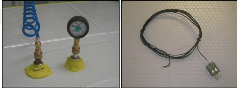
řekil 18: Vakum Portu ve Isı Sensrlerinin Yerleřtirilmesi
