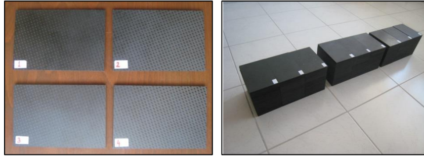
Şekil 29: Ağırılık Düşürme Darbe Testi Numuneleri
