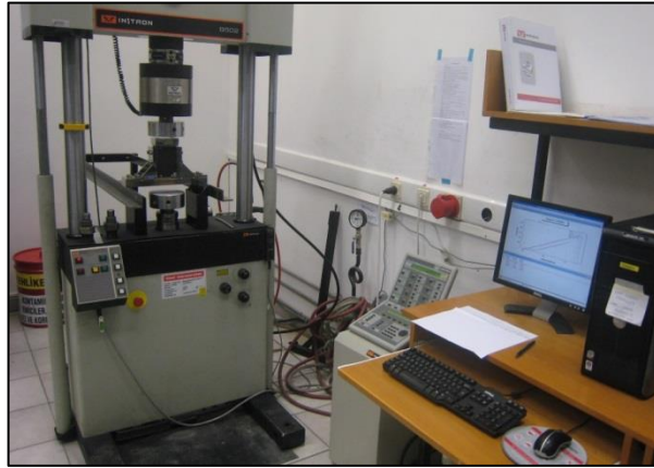
Şekil 38: DSB Dayanımı Test Düzeneği
