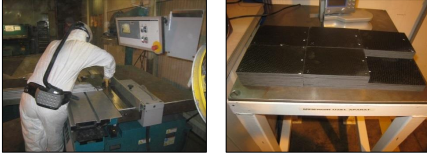
Şekil 21: Numunelerin Kesim İşlemi
