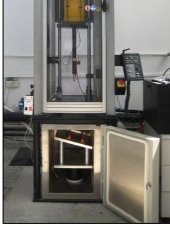
Şekil 33: Destek Aparatının Ağırlık Düşürme Darbe Test Cihazına Yerleştirilmesi
