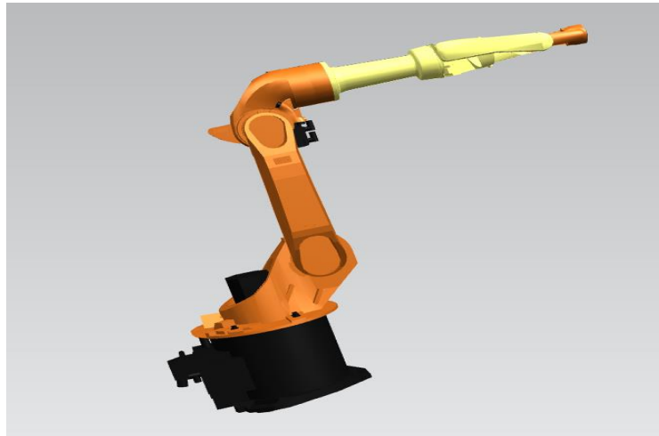
Őekil 1.2 : Altı eksenli bir articulated robot.
