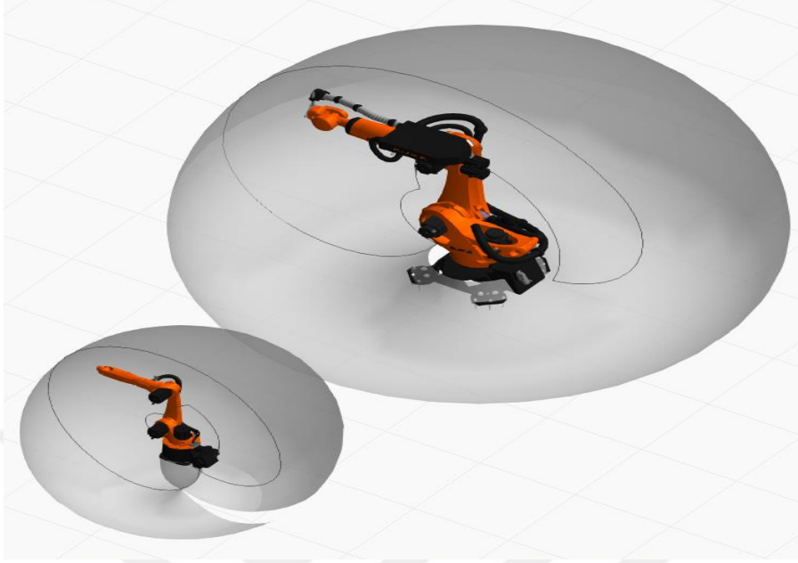
Şekil 1.18 : Altı eksenli taşıma ve punta kaynak robotlarının çalışma uzayları.
