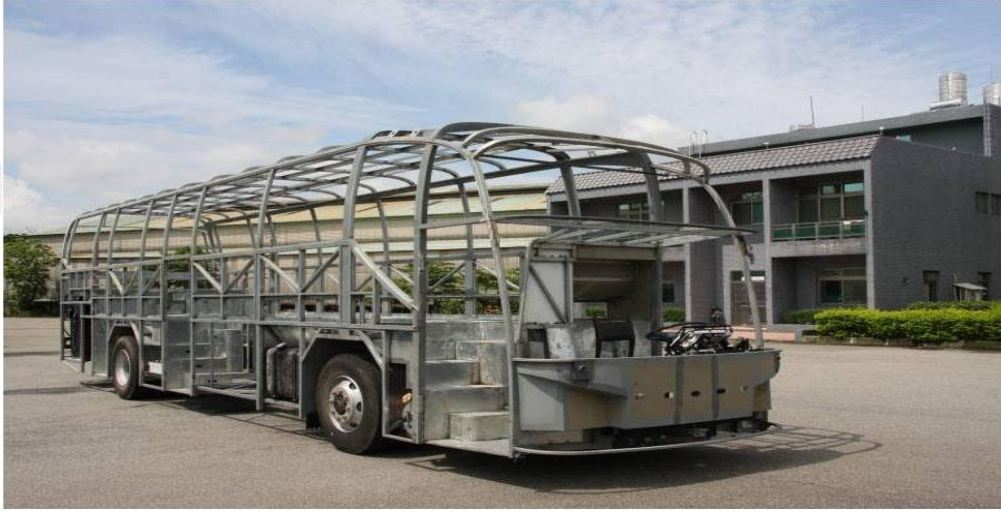
Şekil 1.22 : Bir otobüs gövde yapısı.
