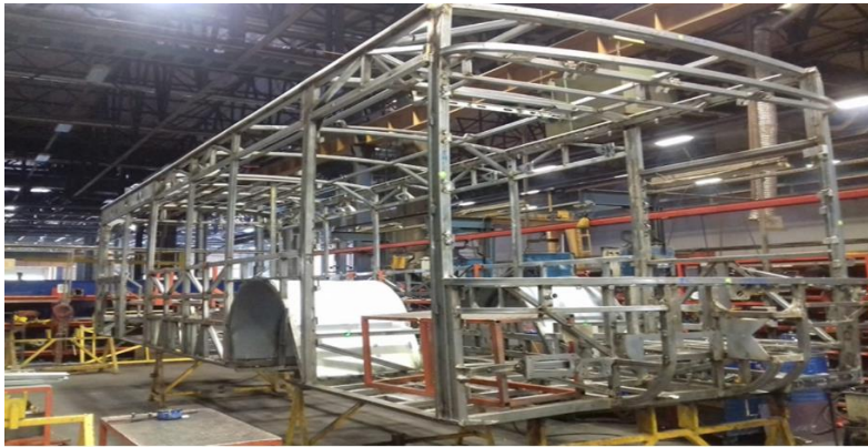
Şekil 1.21 : Taşıyıcı karkas yapısı (Url 3).
