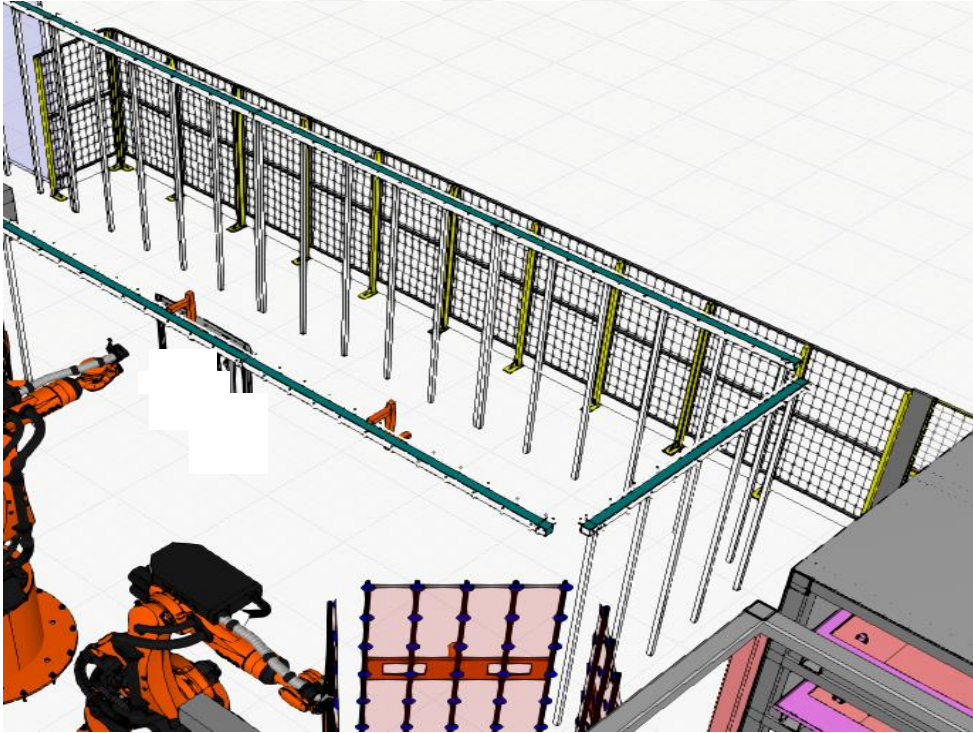
Şekil 2.2 : Free and power konveyör ve tool stand figurative görünüm.
