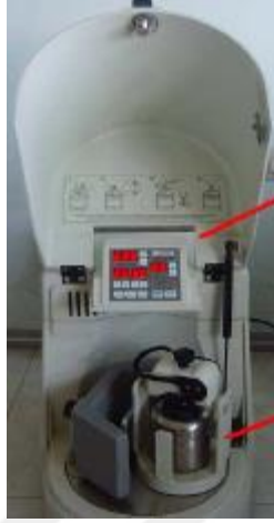
Şekil 5.4. Mekanik Aktivasyon işlemi için kullanılan gezegensel değirmen
