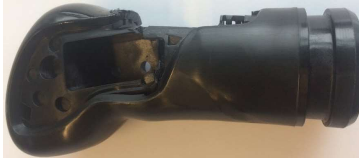
Şekil 5.4 : 700 N yüklem altında kırılan parça.
