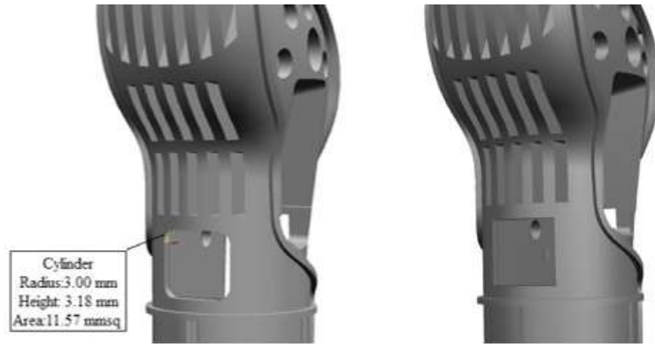
Şekil 2.8 : Gelime miktarını azaltma için köşelerde çentik etkisi azaltılmıştır.
