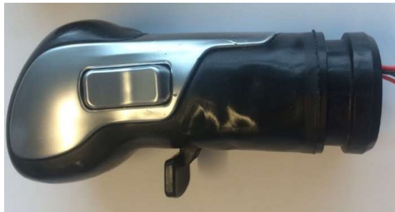
Şekil 5.7 : 310 derece enjeksiyon sıcaklığında yüzey görüntüsü.
