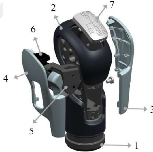
Şekil 1.2: Vites topuzu ana parçaları.
