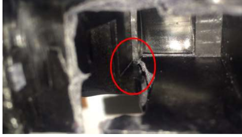
Şekil 5.5 : Kırılma bölgesi daire içine alınmıştır.
