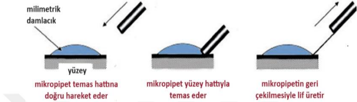
Şekil 2.50 Daha önce biriktirilmiş bir polimer çözeltisi damlasını keskin bir uçla temas ettirerek ve onu sıvı bir elyaf olarak çizerek nano-lifler üreten yöntem
