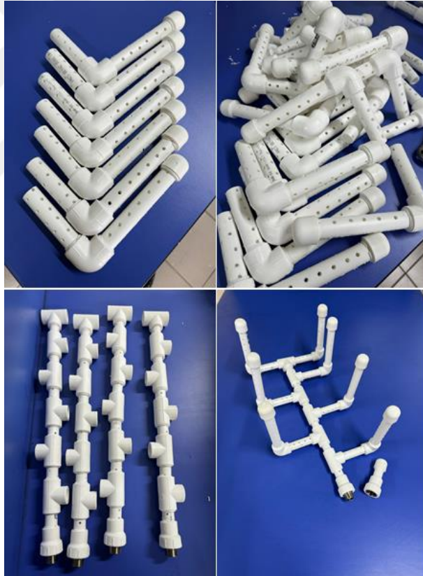
Şekil 3.4. Kompostlaştırma reaktörünün havalandırma düzeneği
