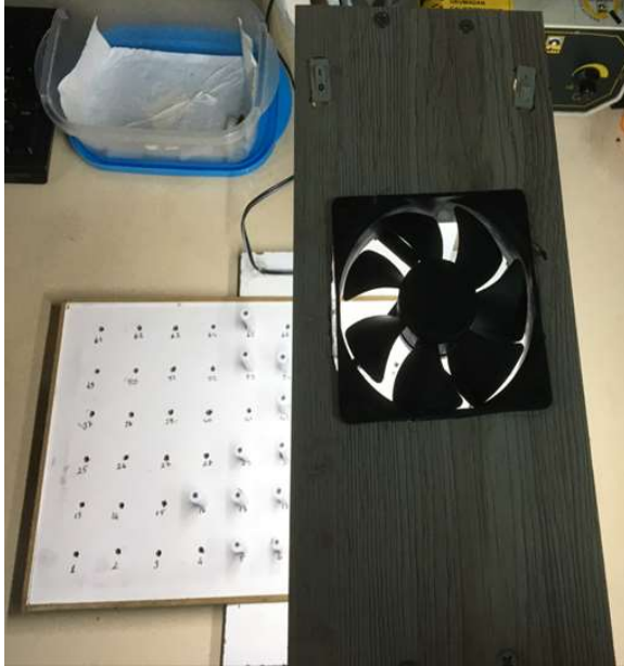
Şekil 11. Elektrotların fan altında kurutulmasına ait görsel
