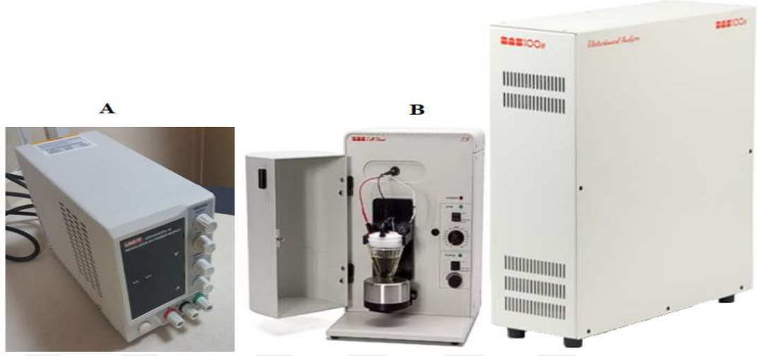
Şekil 10. TI özütleme işleminde kullanılan güç kaynağı (A) ve elektrokimyasal ölçümlerde kullanılan potansiyostat (B)
