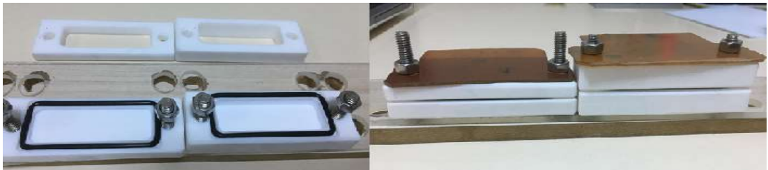
Şekil 13. Açık ve kapalı şekildeki ince ve kalın TI özütleme hücrelerine ait görseller
