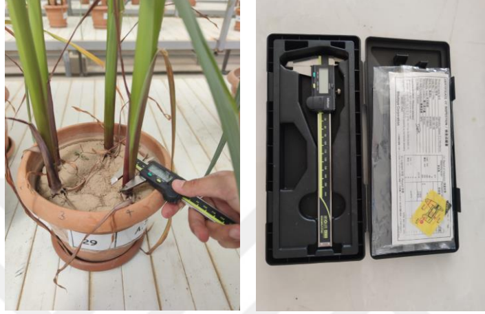
Şekil 3. 13. Mısır bitkisinin gövde çapının ölçülmesi
