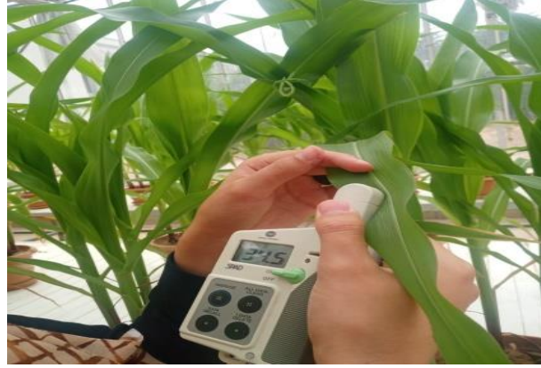
Şekil 3.9. SPAD metre ile nispi klorofil değerin belirlenme
