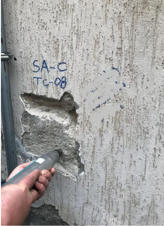
Şekil 4.3 Scmidt çekici testi
