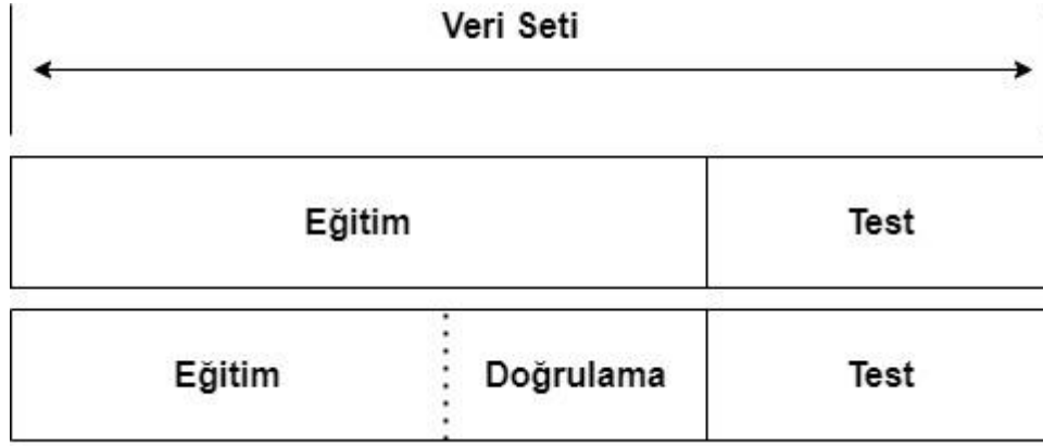
Şekil 3.9. Veri Setinin Eğitim ve Test Verisi Olarak Ayrılması
